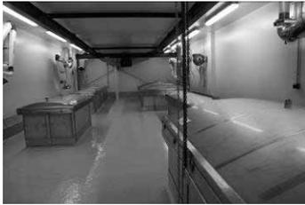
大型魚類處理金屬槽，可完全密閉，採用鐵鍊槓桿懸吊開蓋。
