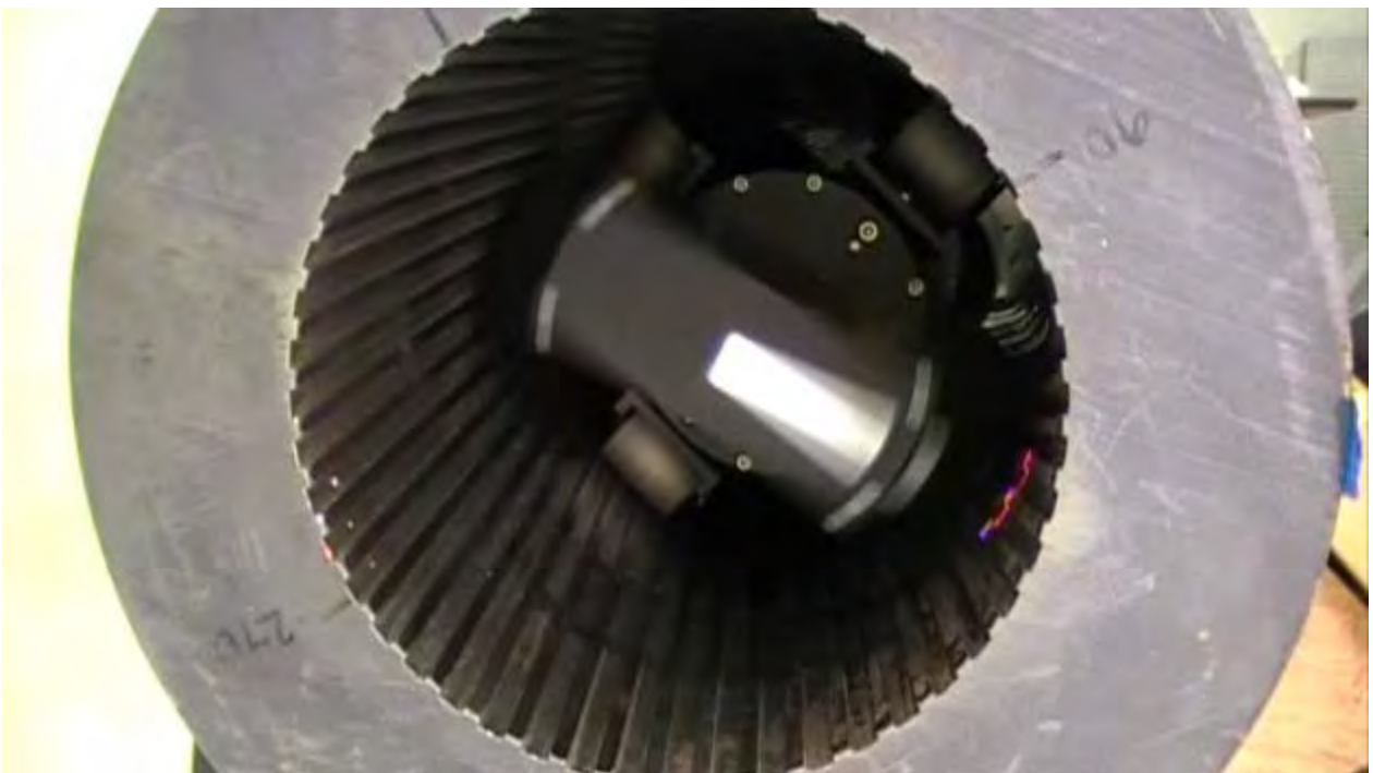
圖 28 砲口拍攝感測器作動情形
