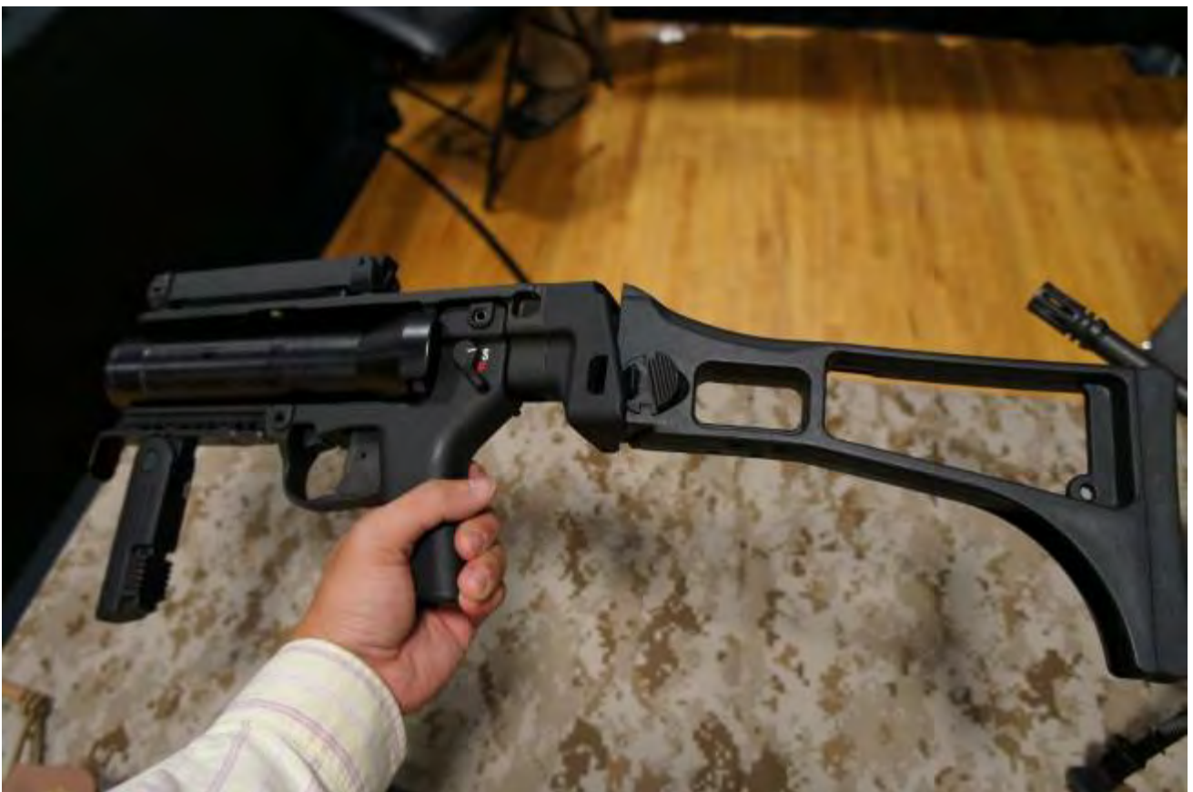
圖 80 按鈕壓下後，槍托已可折疊
