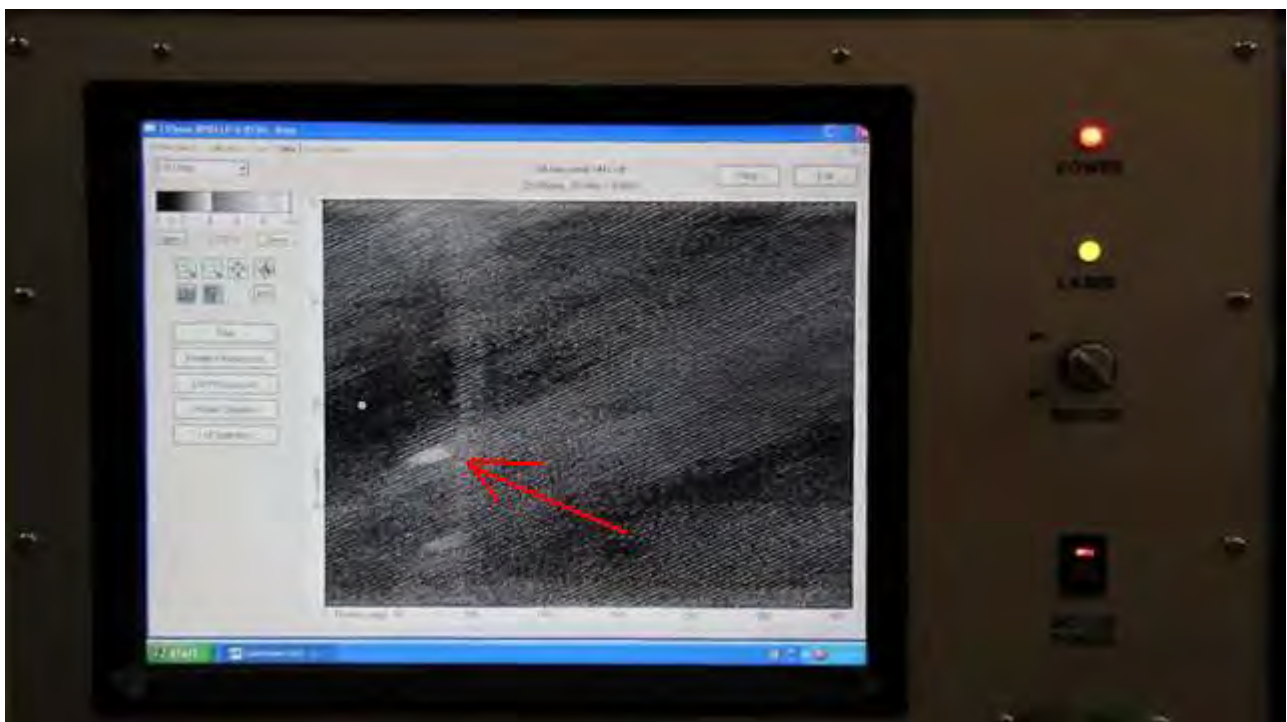
圖 34 發現砲管表面瑕疵
