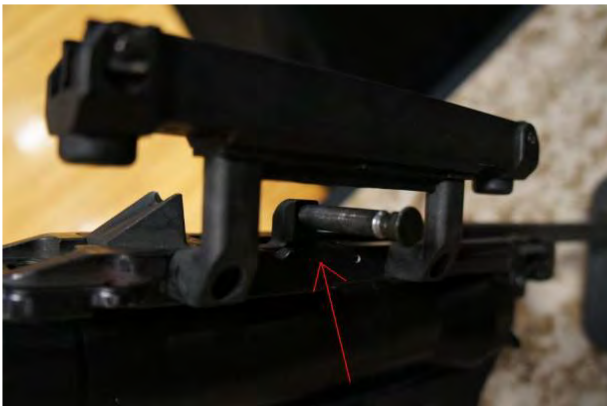
圖 85 插銷拉到底，與步槍結合後，插銷回復到定位，即完成組裝
