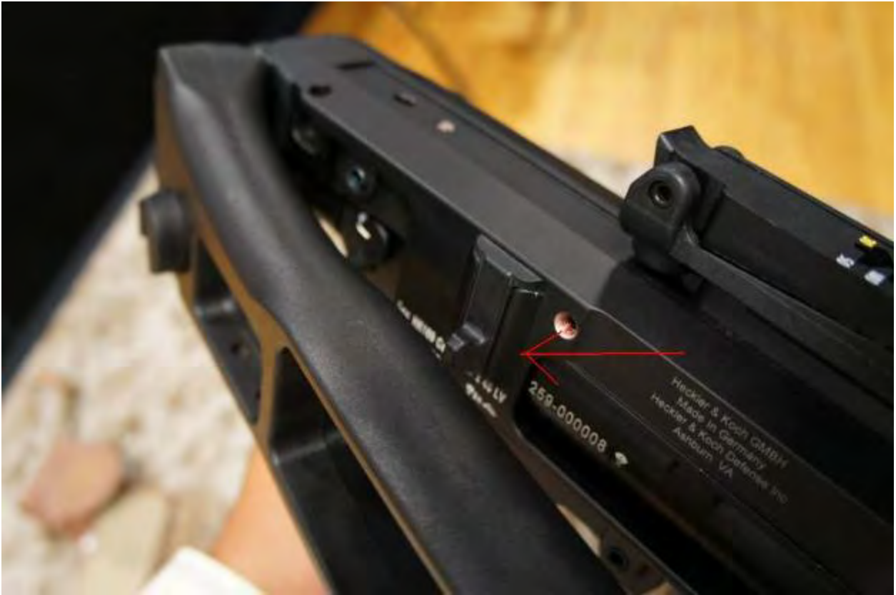
圖 81 摺疊後，槍托嵌進勾型狀設計，即可固定
