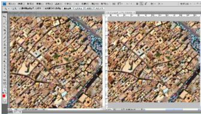
C 縮放顯示工具將 City3 及 City3_a 中物體放大至相同大小>手形工具移動 City3 及 City3_a 依次上而下，左而右詳細比對
