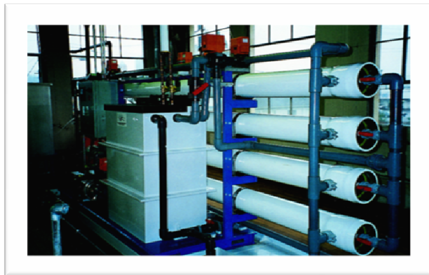
圖 28：逆滲透薄膜處理設備流程圖
