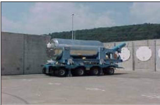
圖 Transnuclear 公司，乾儲設施水平置放之金屬容器(Canister)外加水泥屏蔽(Cask)
