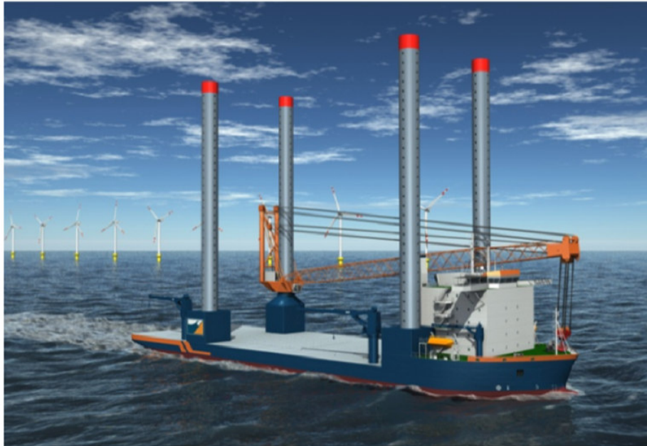
圖 7-5-1 Vestas 公司針對 V112-3.0MW 設計專用的離岸安裝船隻
