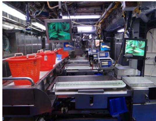
圖 24. Bigelow 試驗船上之漁獲體長體重測與條碼掃描設備
