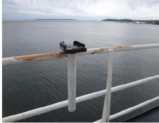
圖 14. 將固定器基座安放於船舷邊之座槽
