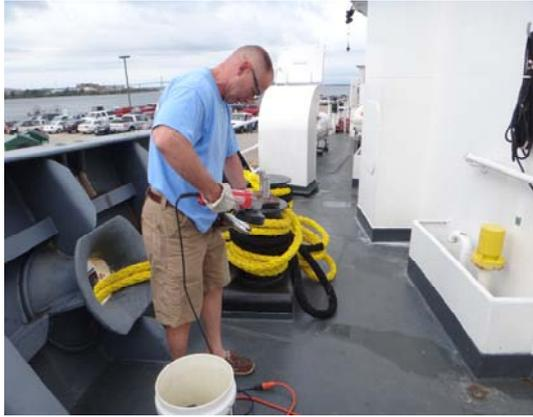
圖 13. 固定器磨平拋光作業
