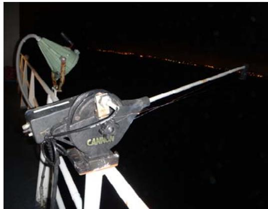
圖 16. 校正竿架安置於船舷基座
