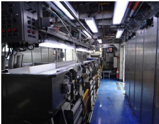
圖 23. Bigelow 試驗船上之漁獲輸送帶
