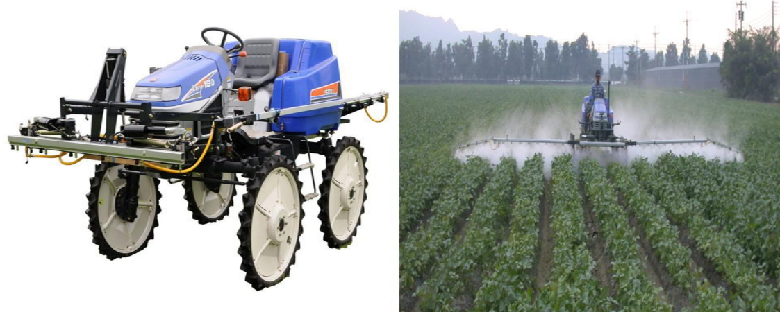
圖 9. 日本井關農機株式會社の桿式噴藥車可利用電腦控制面板精確控制噴灑的農藥量
