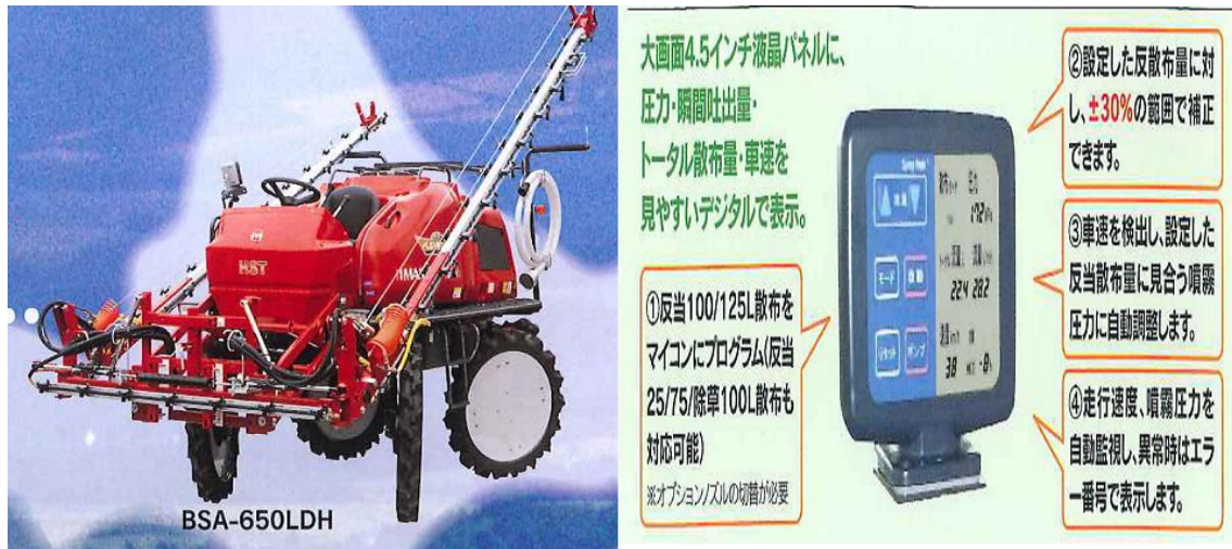
圖 8. 日本株式会社丸山製作所の桿式噴藥車可利用電腦控制面板精確控制噴灑的農藥量
