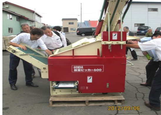
圖 14. 日本北海道本田農機工業株式會社生產的毛豆脫莢機(左)及本田社長(右)親自解說各部的功能
