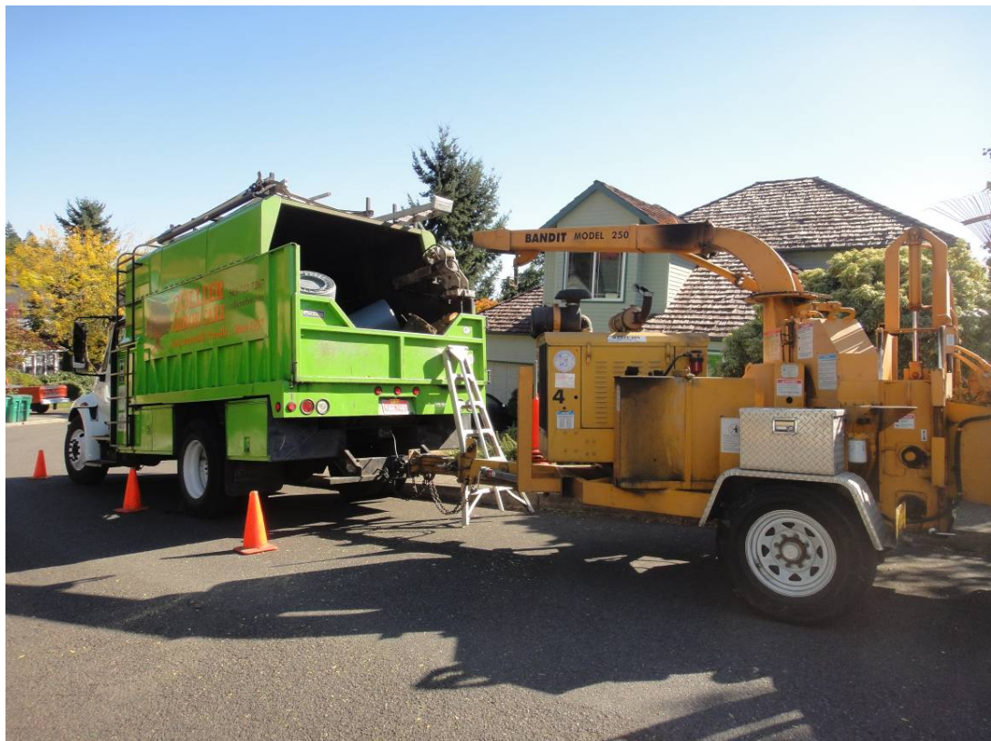
圖 27. 將木材打碎後直接作為土壤有機肥料的器具與過程。
