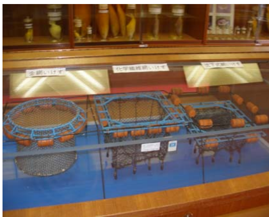
不同樣式及材質之箱網模型
