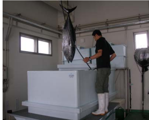
收獲後黑鮪冰水預冷設備操作
