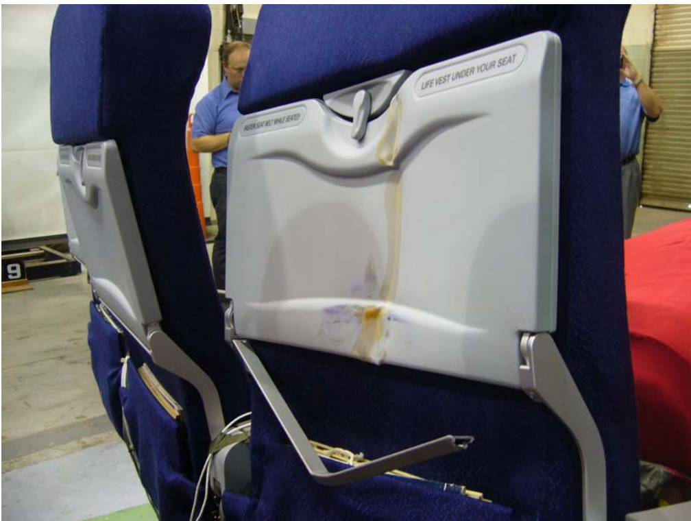
測試後餐盤支架斷裂，須進行後續設計改良
