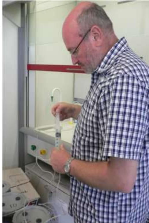
圖十八、脫氮潛勢測定使用電石產生乙炔氣體
