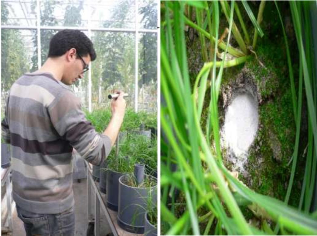
圖十六、以土鑽採集土壤樣本並回填石英砂
