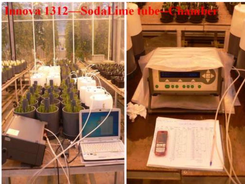
圖十五、系統設置示意圖（儀器主機、鹼石灰管柱、連接管與密閉罩）
