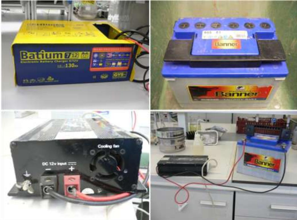
圖二十、荷方建議田間量測使用蓄電池搭配變壓整流器（避免發電機油氣干擾）
