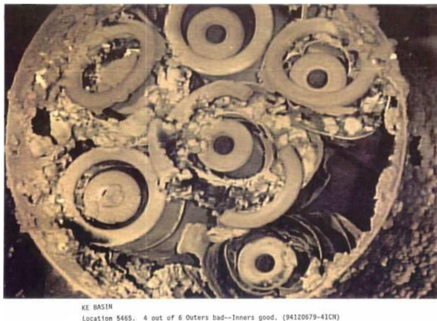
圖 十五 K-East 內之用過金屬鈾燃料毀損與腐蝕情形
