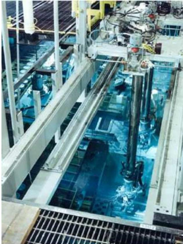
圖 二十三 Schilling Robotic Systems — CONAN 機械臂水下裝填燃料
