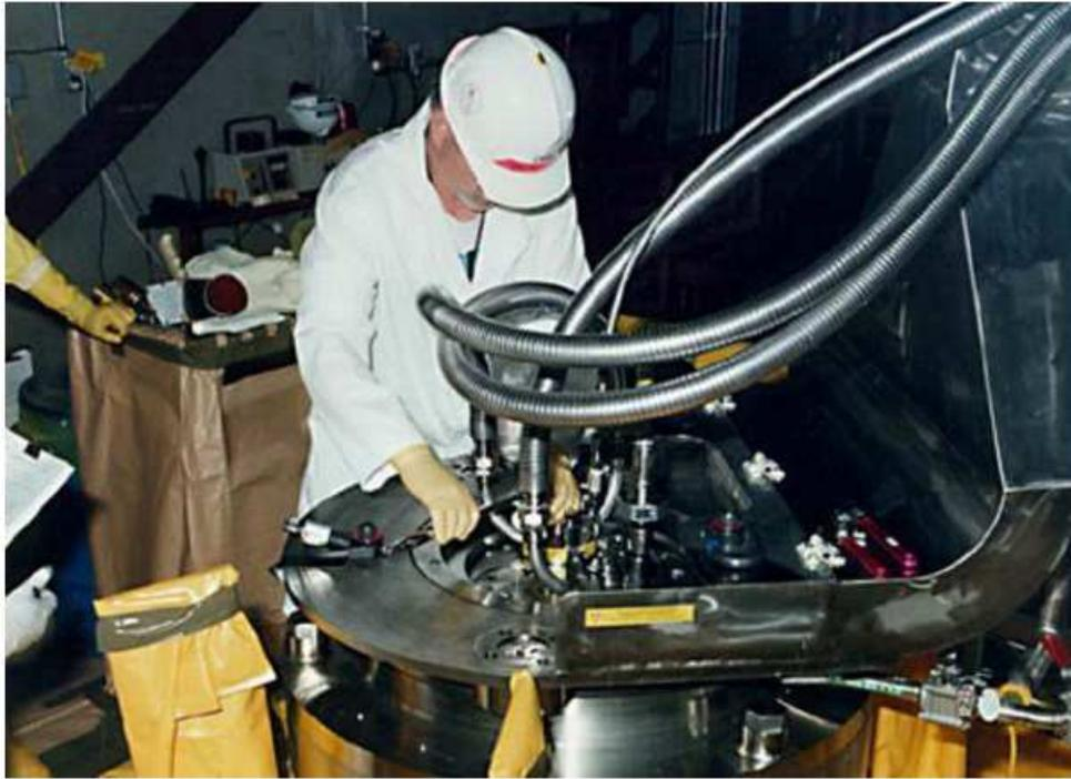
圖 二十五 多道式重裝罐 MCO 進行真空乾燥程序
