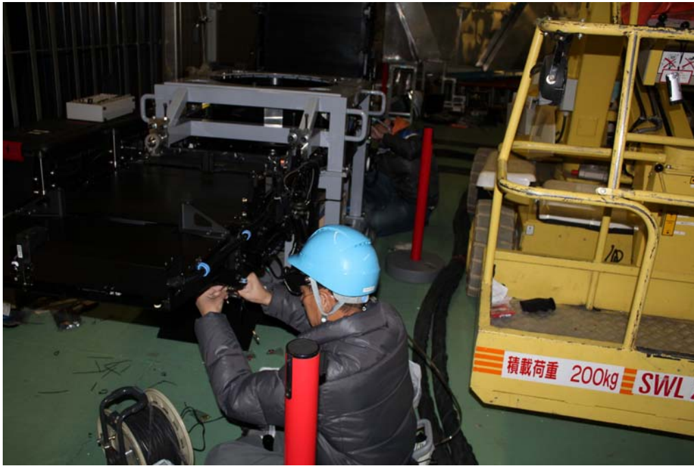
圖 三十三、我方工作人員執行下死點感測器佈線
