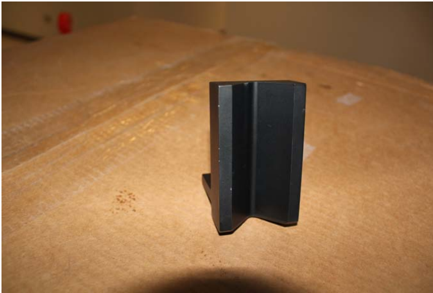
圖 一、舊型介面機匣上之 V 型導軌
