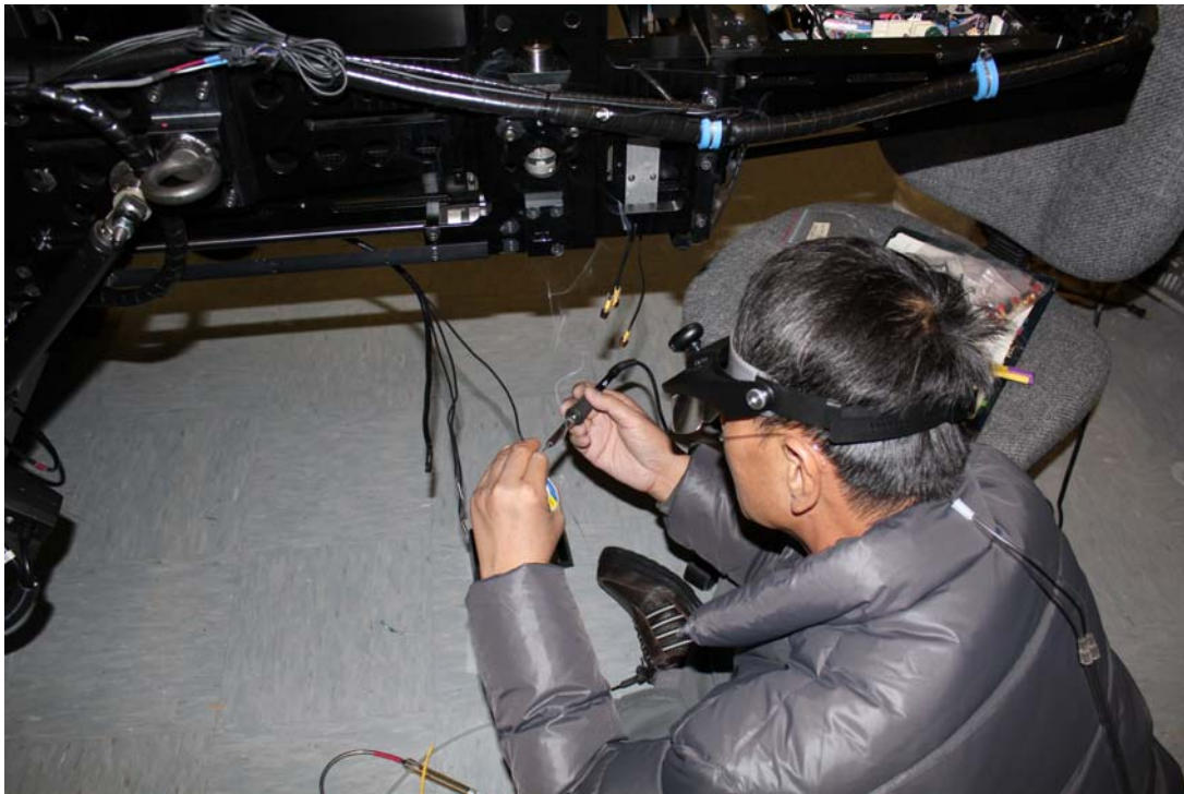
圖 三十、近接開關轉接頭焊接
