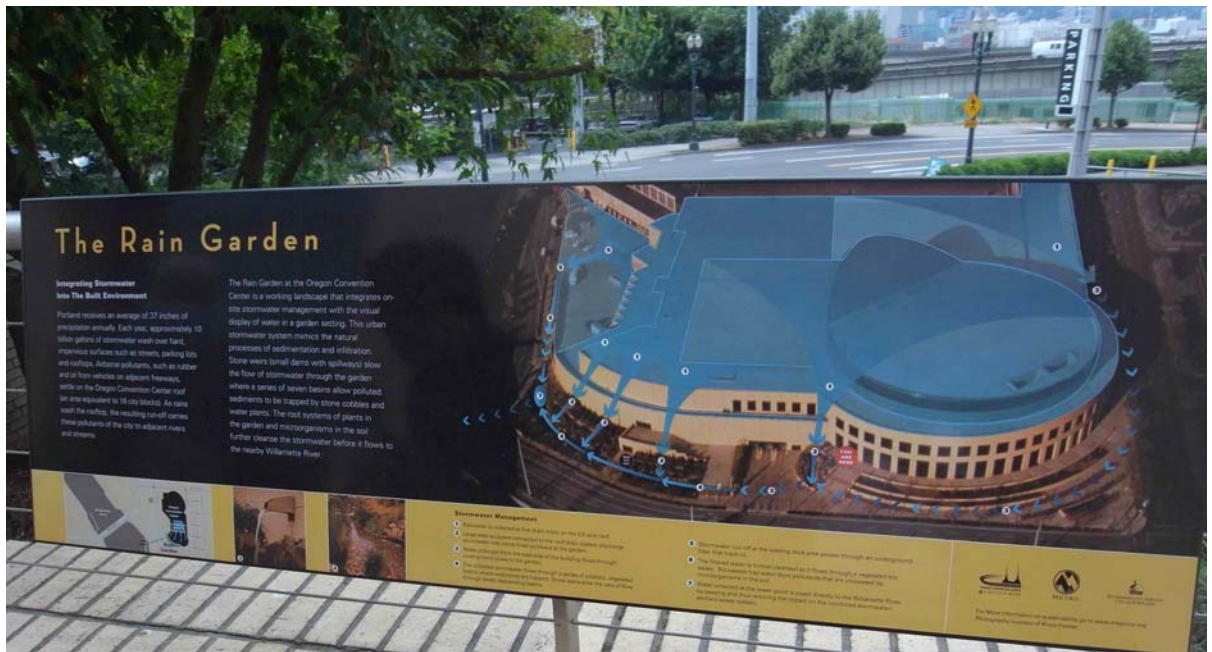
圖 8、波特蘭市會議中心的雨園（The Rain Garden）設計教育解說圖版，利用大面積屋頂匯集雨量，規劃排流網絡。
