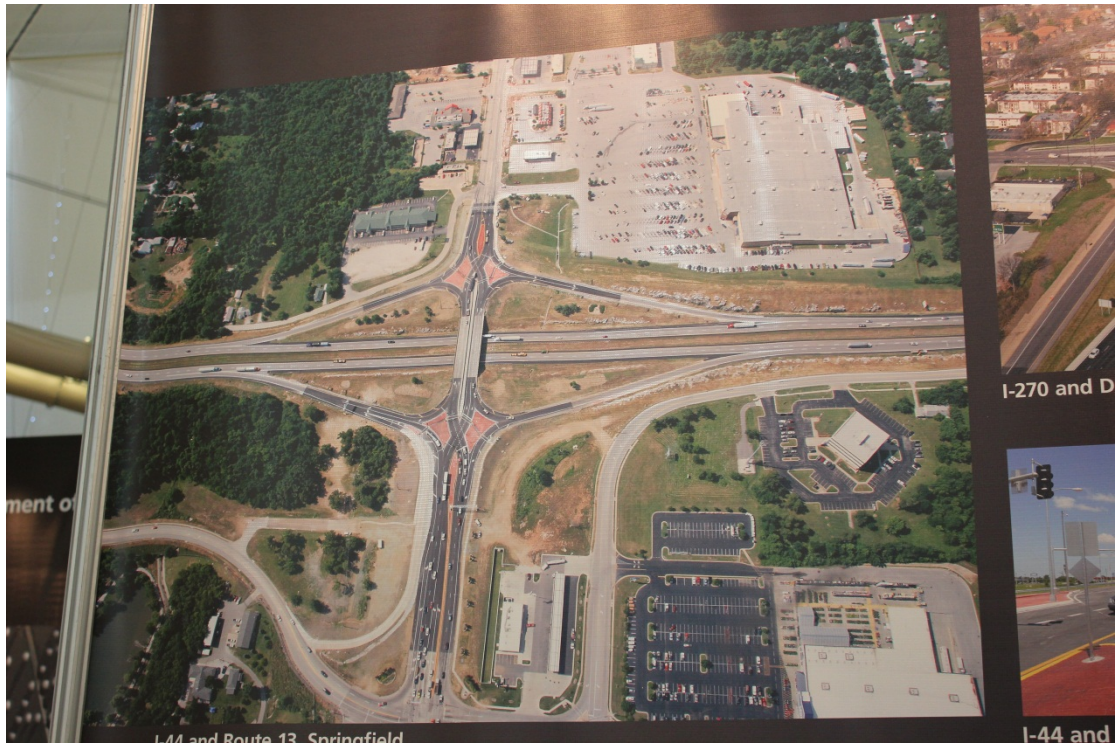
圖 5：分歧式鑽石型交流道(Diverging Diamond Interchanges)。此設計主要是讓出入高速公路的左轉車輛在進出聯絡道時，駕駛員可以減少停等紅綠燈號誌的次數，並減少車流交織的狀況，讓車流更為順暢，且不需增加用地需求。
