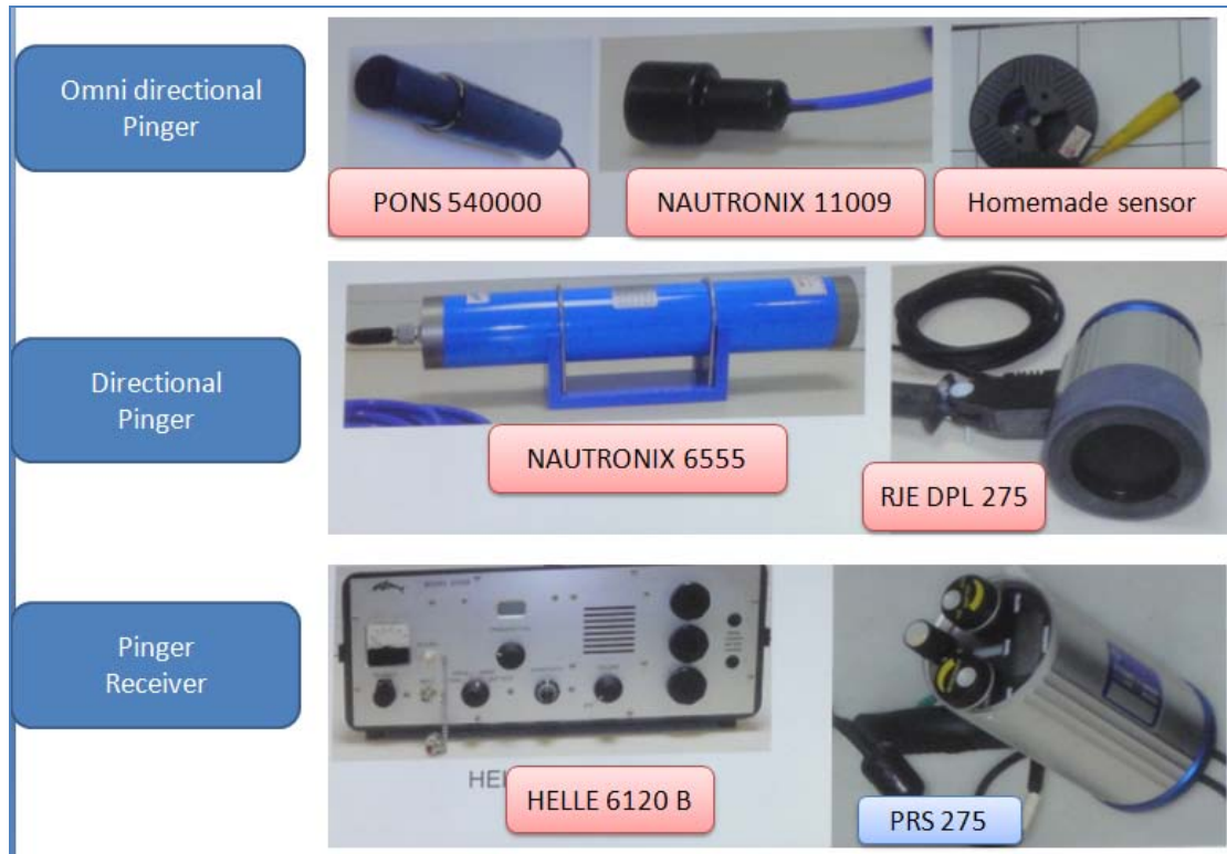
圖 15 BEA 現有各式飛航紀錄器水下偵查系統之裝備圖
