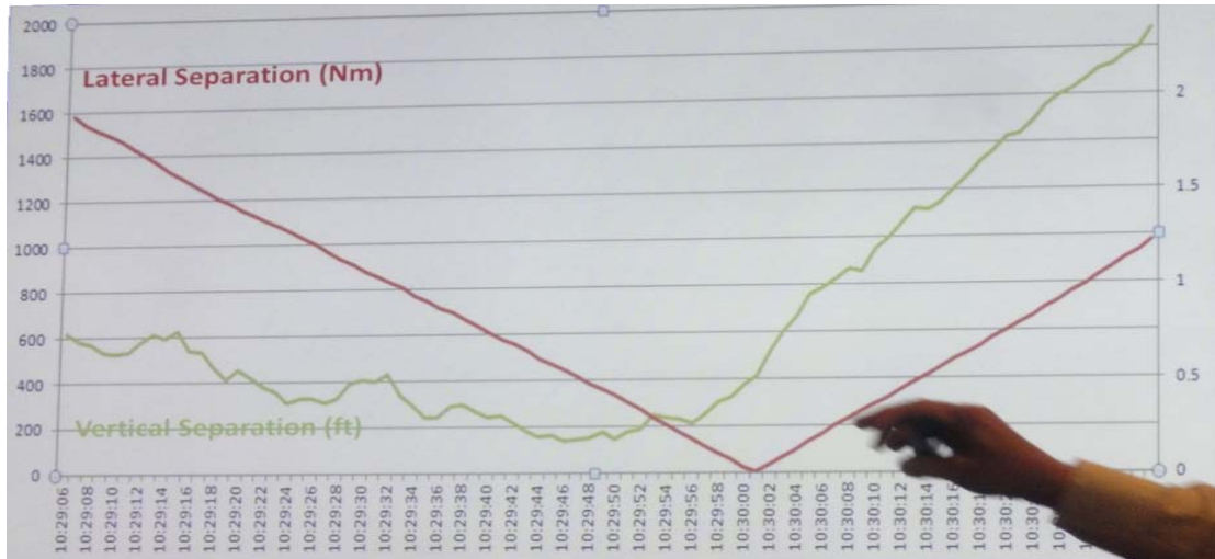
圖 20 兩架航空器發生 TCAS RA 警告期間的隔離變化圖
