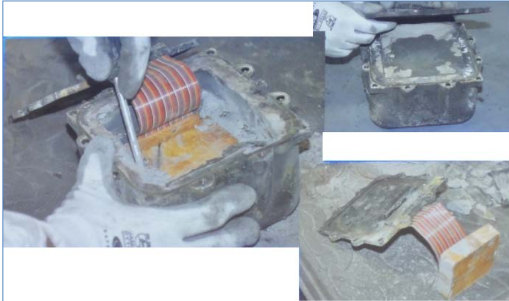
圖 5 某 L3-COM F1000 型 FDR 之損壞 CSMU 外觀圖
