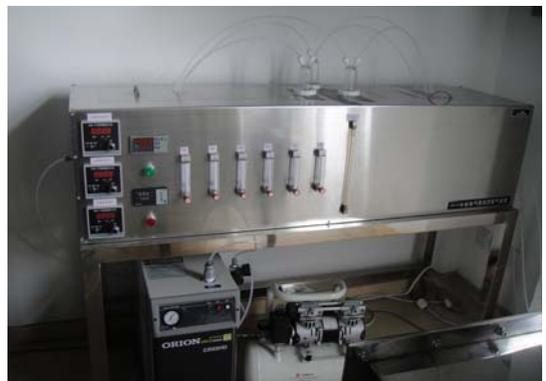
大型測試艙甲醛採樣設備
