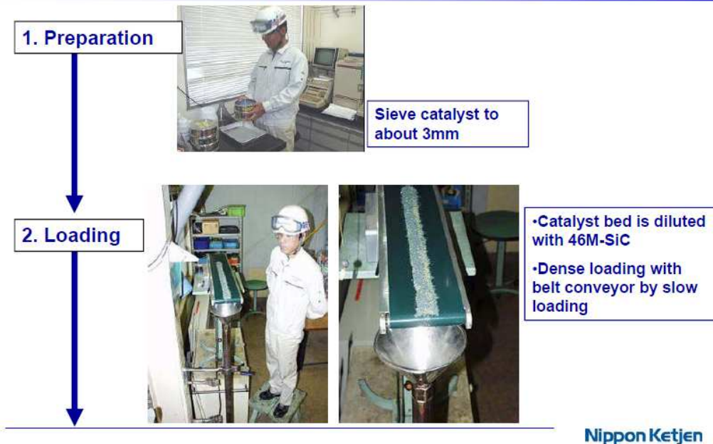
圖七、觸媒詳細裝填方式
