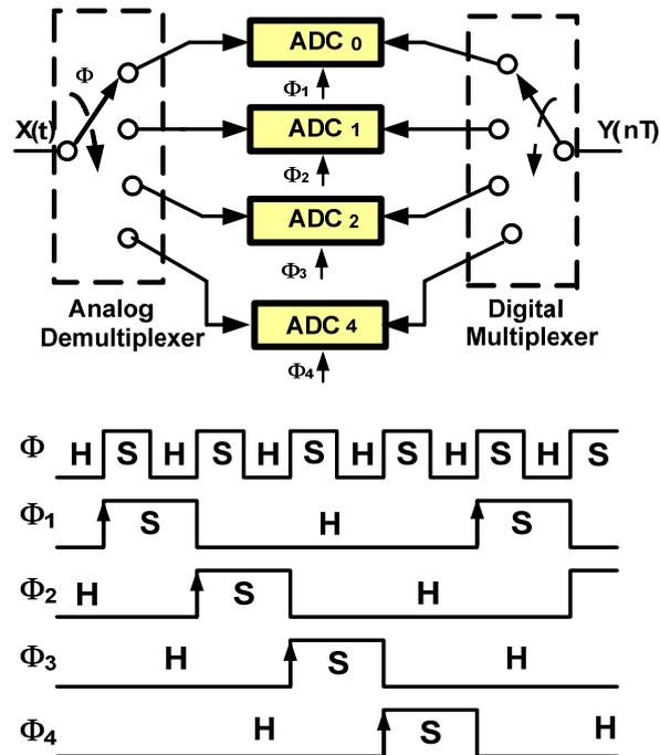
為了克服不理想效應，有些會從類比電路方面直接去做校正，但類比校正的特性也往往需要 trade off 難以兼具，此次會議中專家們大部分採用數位的校正方法去校正上述所產生的效應。所發表的 Time-interleaved ADC，主要對於通道間 mismatch 的校正主要為兩種，即前景式校正(foreground)及背景式校正(background)，其中因為前景式校正必須在校正時停下 ADC 的運作，並且在校正中對 ADC 有諸多的條件，故前景式校正已經較少在使用。現在大部分使用數位背景式校正，利用數位控制及 LMS 演算法使通道間的 mismatch 減少，而大部分發表文獻都在 Gain 和 Offset 做校正，個人評估可由取樣時間校正做為研究之切入點。
