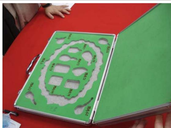
特製文物保護箱為金屬材質，最外層為仿行李箱樣式，有輪子與把手，便於移動，內有七個小手提箱，可單獨提拿，箱內已有按文物形狀事先切割好的泡棉座
