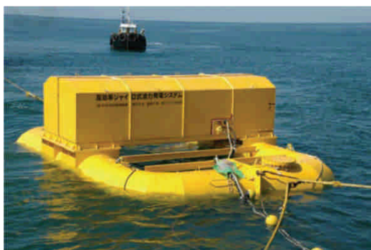
照片 2 系統 2 型波力發電機
