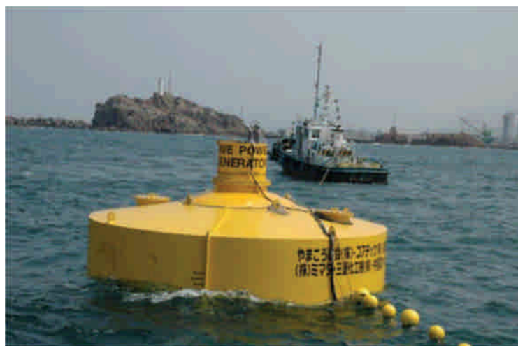
照片 1 系統 1 型波力發電機
