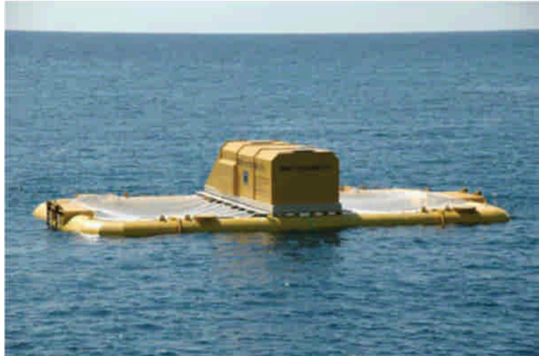
照片 3 系統 3 型波力發電機
