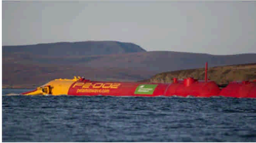
圖 8 Pelamis 波能發電現地佈置圖
