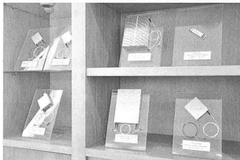
圖 6-1：左上為支援 SSF 之產品；左下為 MLR 系列；中上為 100Gbps 同步模式轉發器；中下為 40Gbps 同步模式轉發器；右上為 SSF 可插拔之產品；右下為 CTT 系列。
