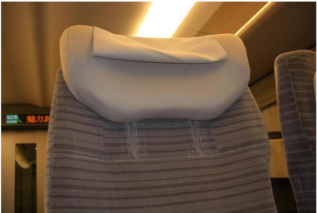
附圖 80：座椅移動式頭套(雙條及雙向拉鍊設計)
