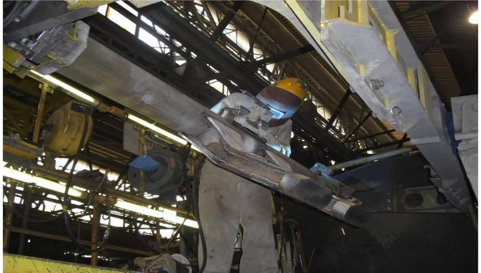
附圖 18：架框組焊(採用常保朝下焊接施工，及大型迴轉治具。)
