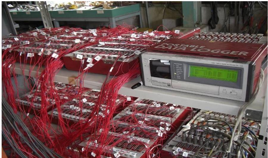
附圖 34：轉向架框靜態負荷測試實況(應變數據收集)
