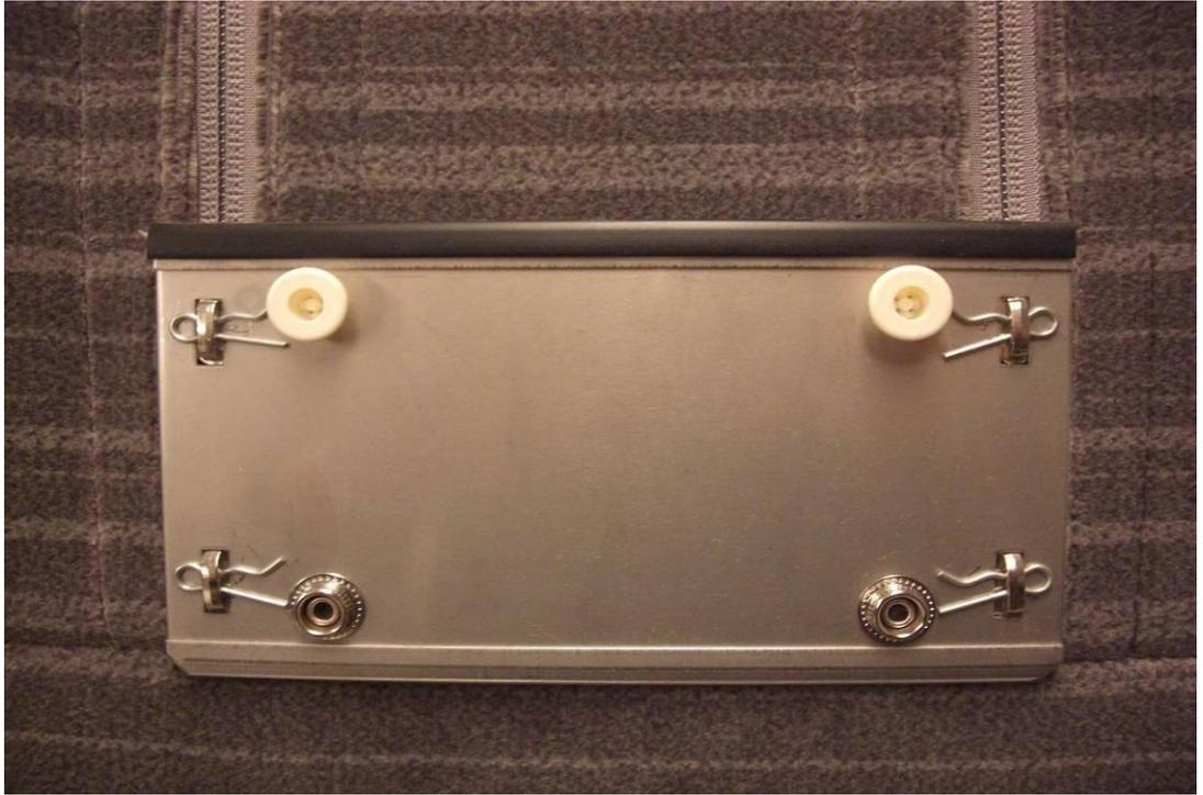
附圖 81：座椅移動式頭套與椅靠連結面(不銹鋼板介面與扣環)
