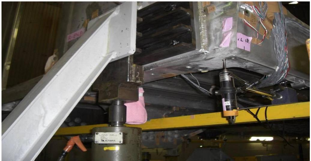
附圖 9：防爬器壓縮－垂直荷重試驗檢測實況(垂直施力處)
