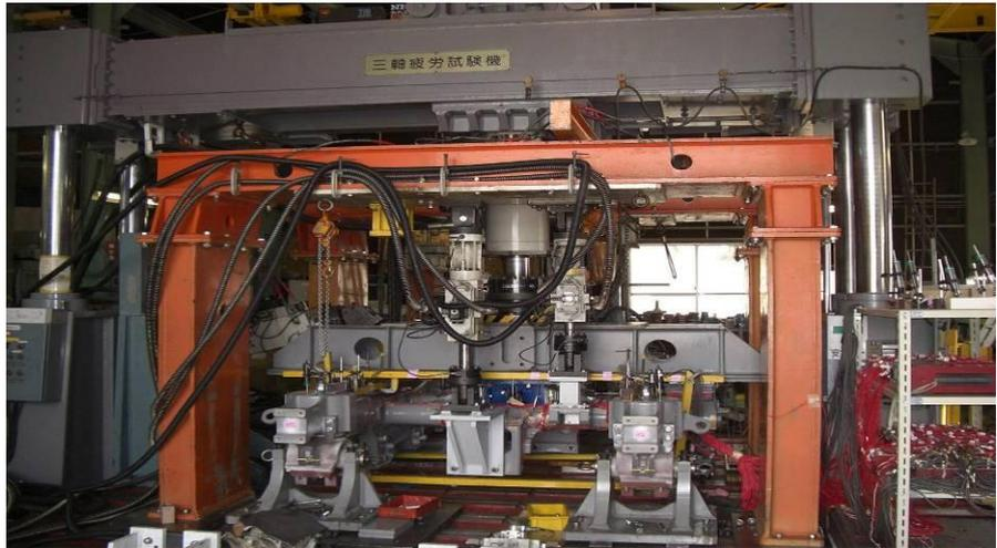
附圖 33：轉向架框靜態負荷測試實況
