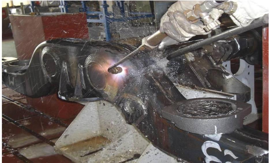
附圖 22：框架熱校正及應力消除(火焰法)
