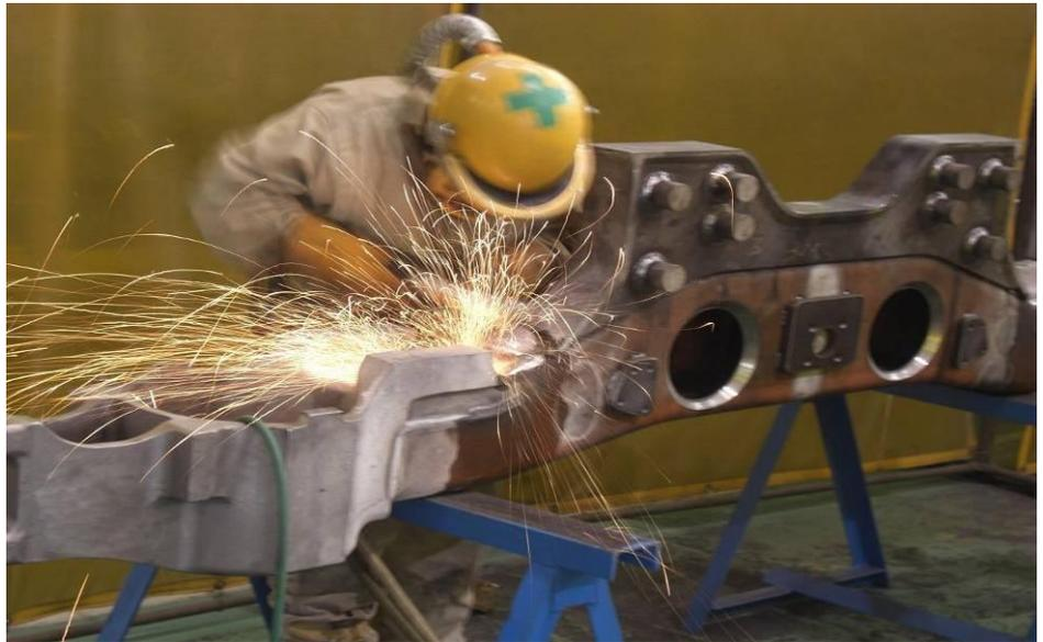
附圖 19：框架組焊完成，焊接處等打磨(打磨應力消除法)
