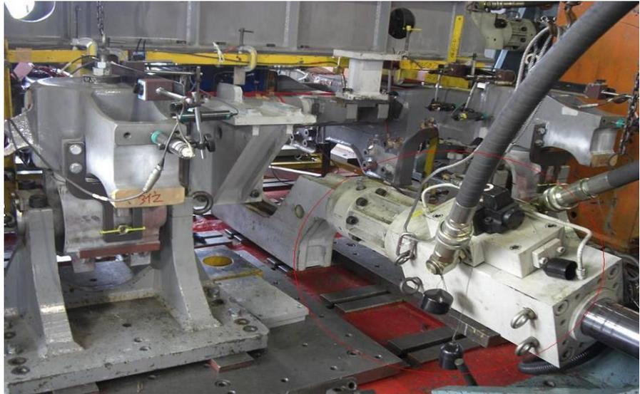
附圖 36：轉向架框靜態負荷測試實況(前後負荷設備)
