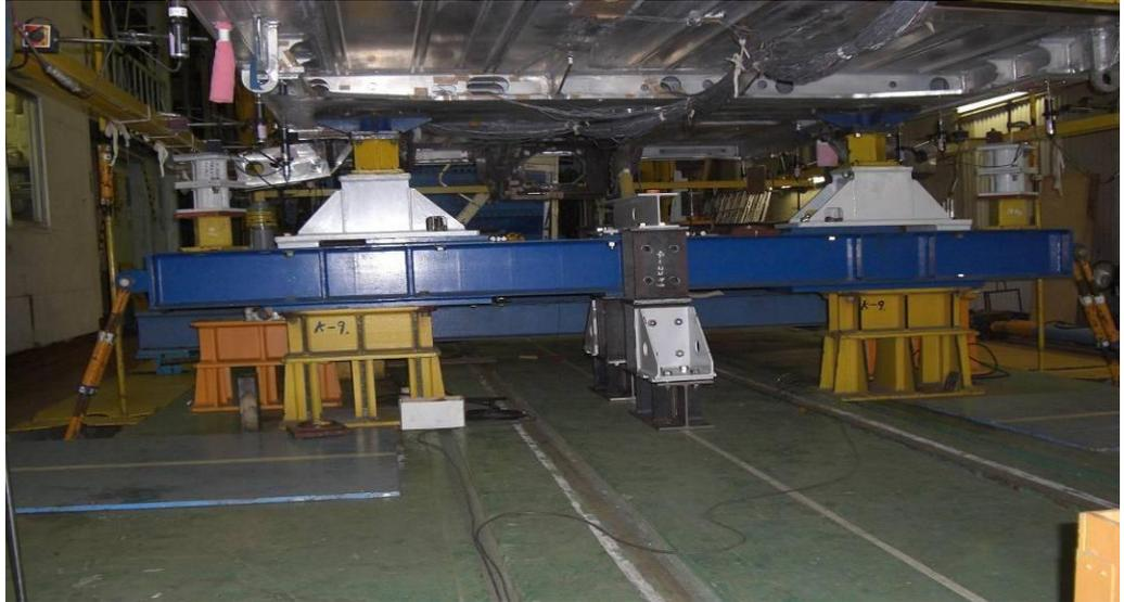
附圖 8：防爬器壓縮－垂直荷重試驗檢測實況(枕樑支撐處)
