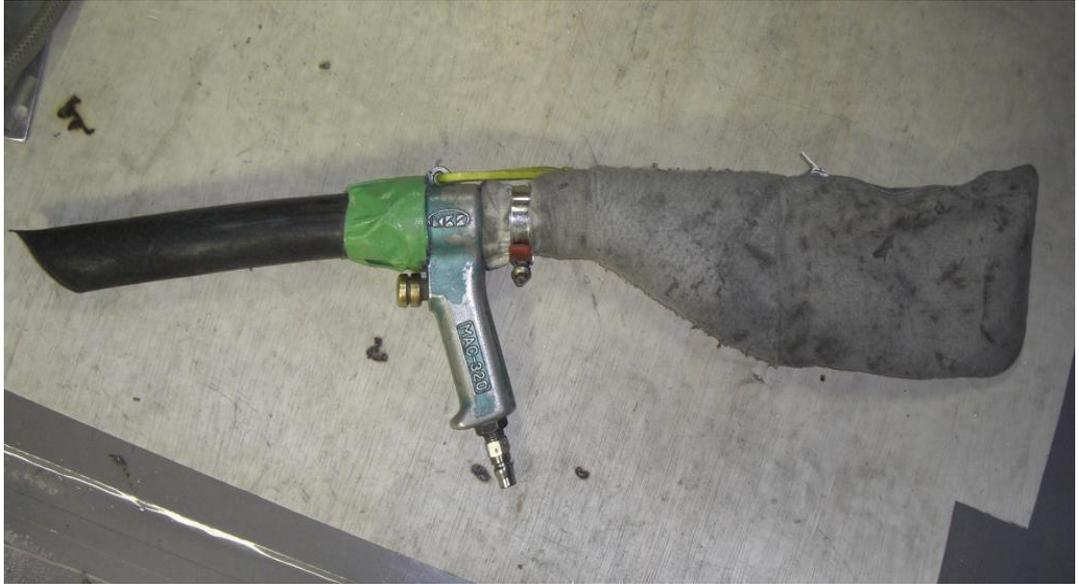
附圖 83：簡易可攜帶式氣動式集塵器
