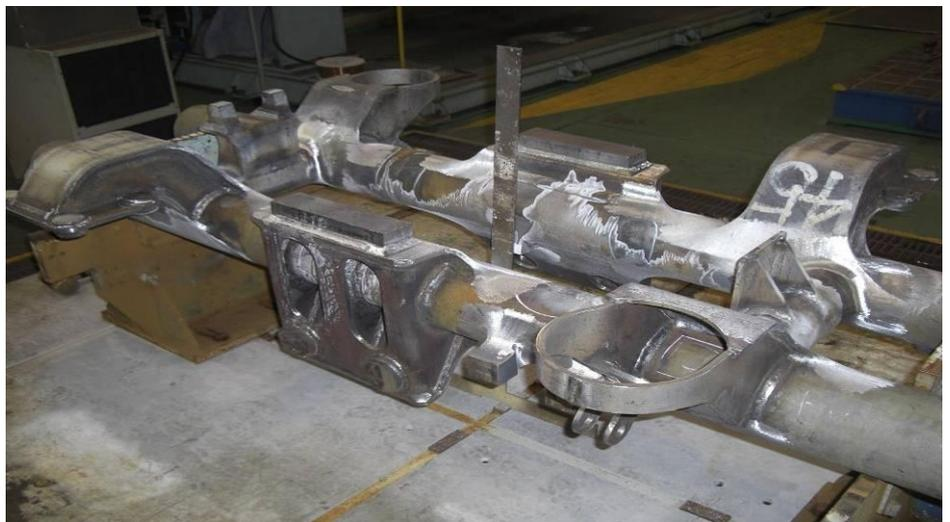
附圖 20：框架焊接處完成打磨應力消除
