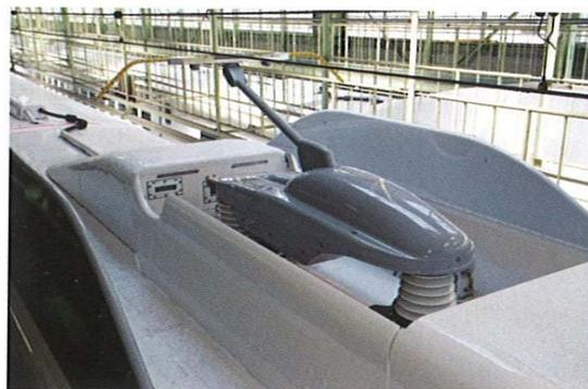
圖93：集電工設備導流罩
