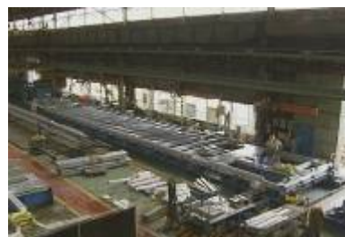
圖16：車台框架製作
