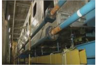
圖22：車身完成荷重測試
