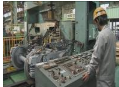
圖61：轉向架迴轉試驗
