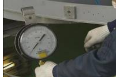
圖64：空氣系統加壓測試
