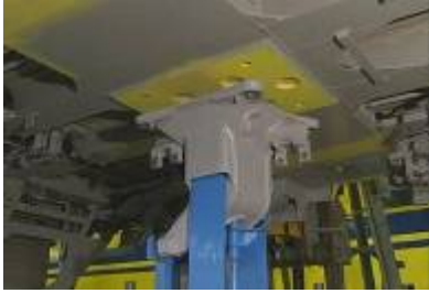
圖62：轉向架固定中心架
