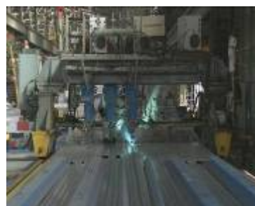
圖10：大型自動熔接機器
