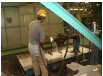
圖53：尺寸角度校正
