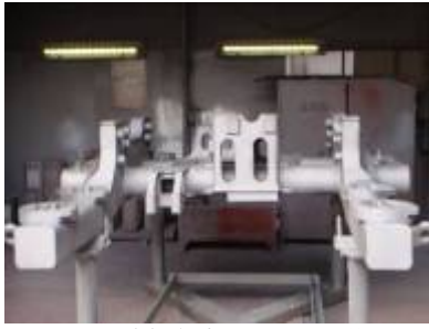
圖56：轉向架框塗裝作業
