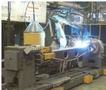
圖51：機器手臂自動焊接
