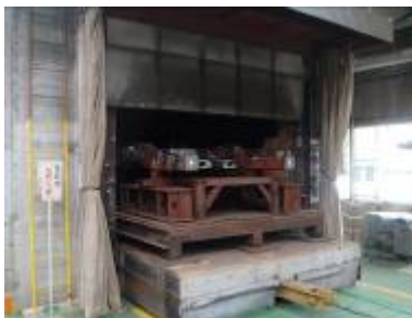
圖55：轉向架框回火處理
