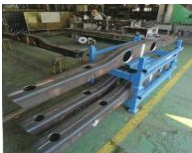
圖50：轉向架基礎鋼材成型
