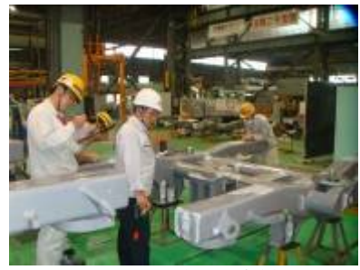
圖58：加工後尺寸檢驗
