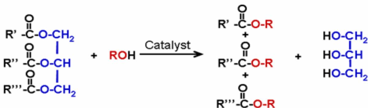
脂肪酸分子結構分為下列五種, 十六個碳飽和的棕櫚酸 (Palmitic Acid)、十八個碳飽和的硬脂酸 (Stearic Acid)、一個不飽和雙鍵的油酸 (Oleic Acid)、二個不飽和雙鍵的亞麻油酸 (Linoleic Acid) 及三個不飽和雙鍵的次亞麻油酸 (Linolenic Acid), 不同成份的脂肪酸甲酯作為生質柴油在凝固點、十六烷值與氧化安定性的特性表現也不同, 飽和棕櫚酸及硬脂酸甲酯
