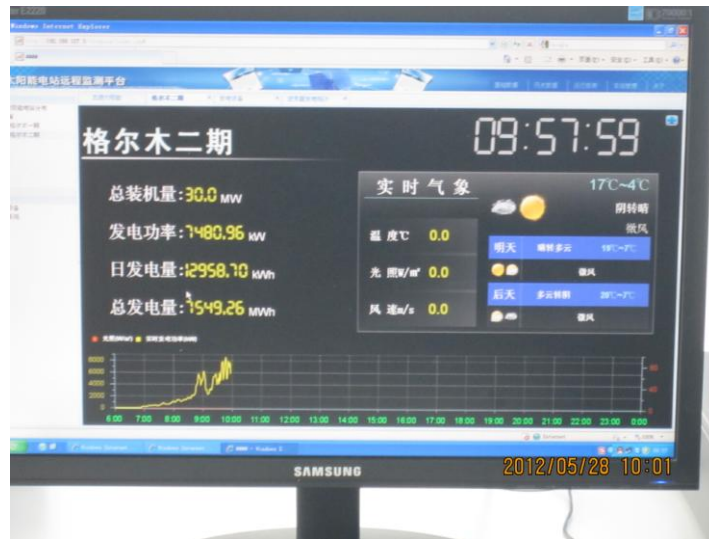
圖 24 國電龍源太陽能發電站中控系統
