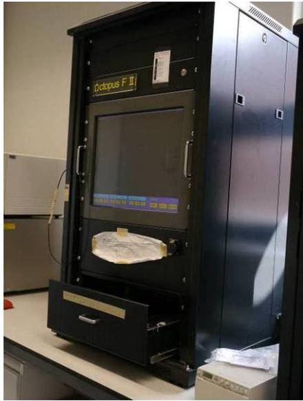
圖 9、電泳膠片照膠系統
