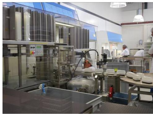
圖 68、培養基自動充填機
