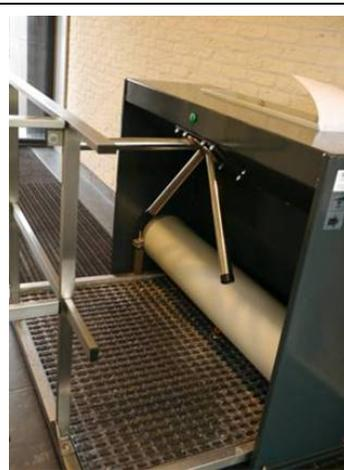
圖 35、Rijk Zwaan 種子公司的溫試進入前的手及鞋子的消毒機器
