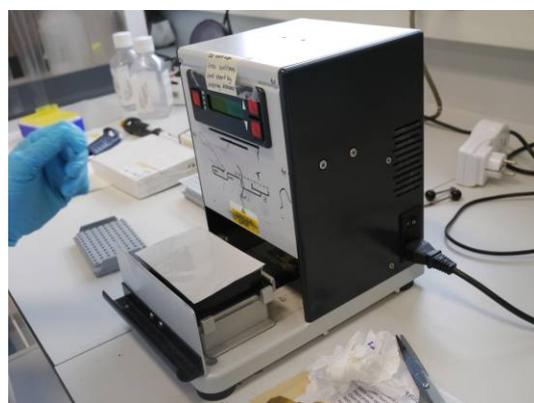
圖 30、盤式 PCR 的封膜機
