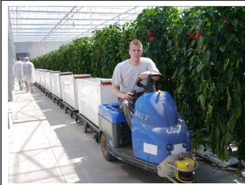
圖 50、VOF P. Solleveld 公司的甜椒收集車滿載時經小型拖車載至自動分機
