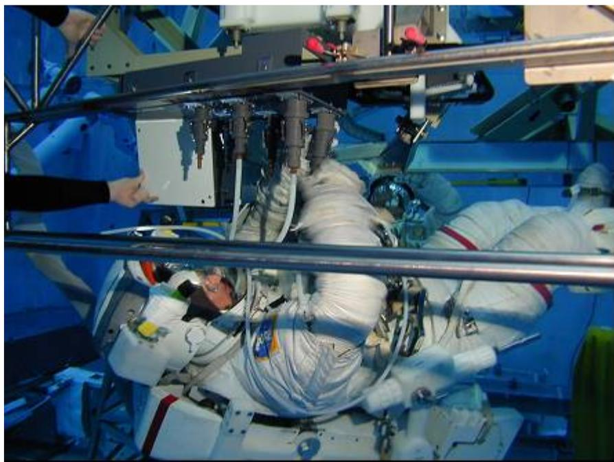
圖一六四：太空人於 NBL 實驗室模擬意外事故時 AMS 資料纜線置換作業
