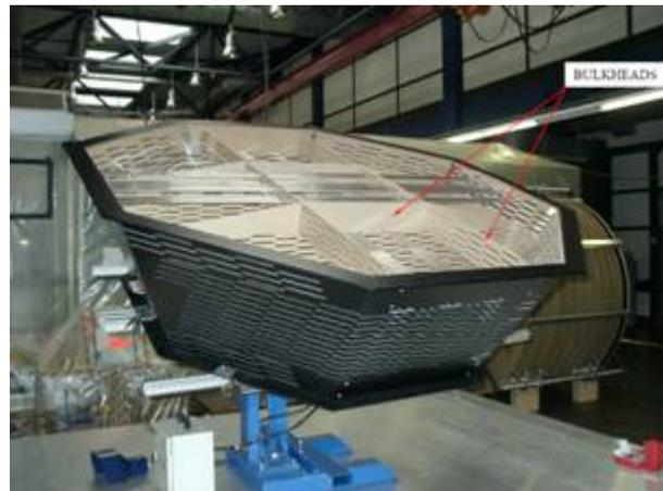
圖二一一：TRD 內部結構及分隔板
