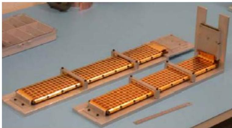
圖一九八：Ladder 感測元件
