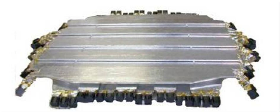
圖七：飛行時間偵測器
