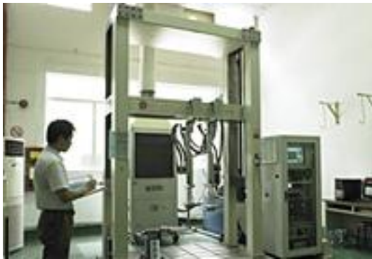
自行車避震前叉測試設備
