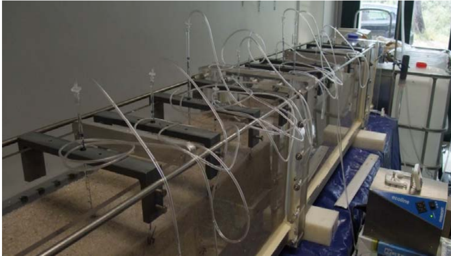
Dispositif de suivi d'une injection de nanoparticules de titane
