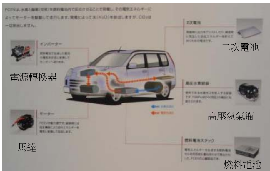
圖 13：日產的燃料電池車內部組件說明
