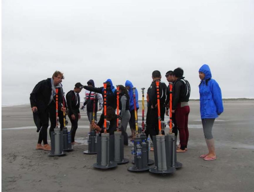
圖 10 現地作業 Field Work，於鹿特丹港出海口北側 's-Gravenzande 的沙灘進行之沿岸流浮標施放作業
