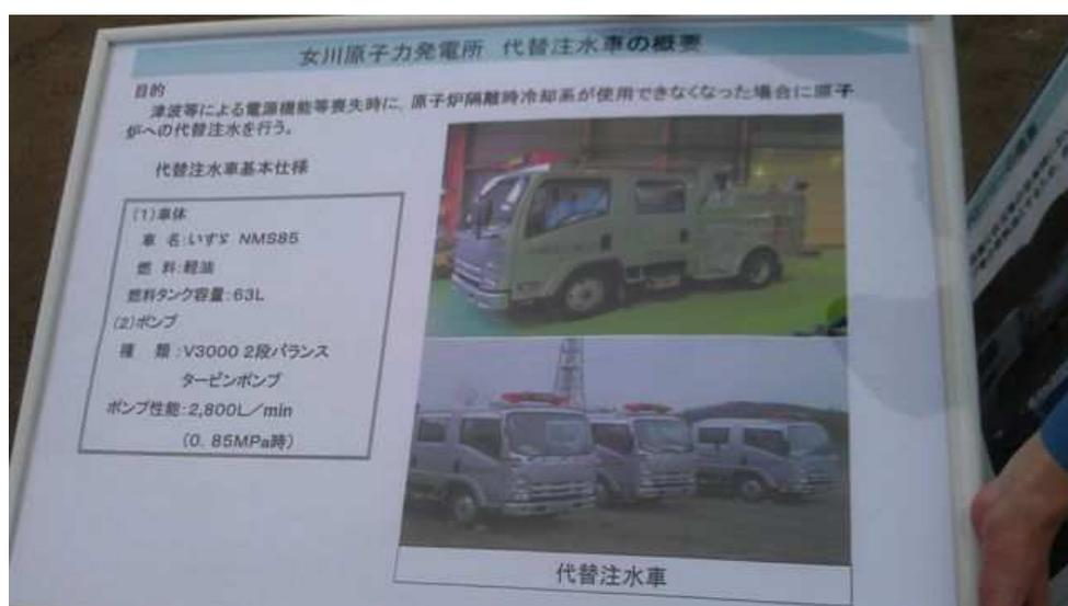
圖 11-1：女川電廠移動式注水車特性
