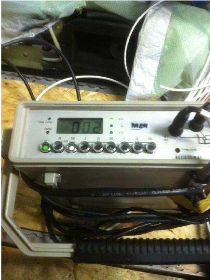
圖 4.2.4 天線接地地阻測量
