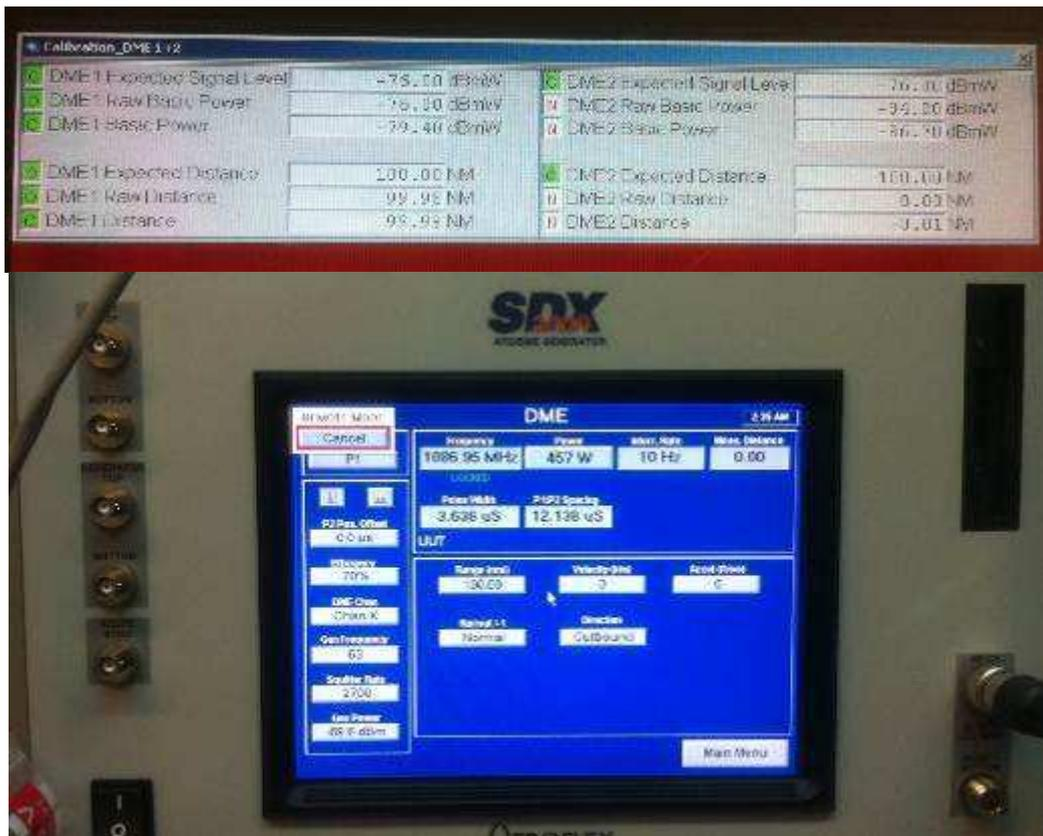
圖 4.4.2.4 Calibration NAV MDE 接收機與太康模擬機畫面
