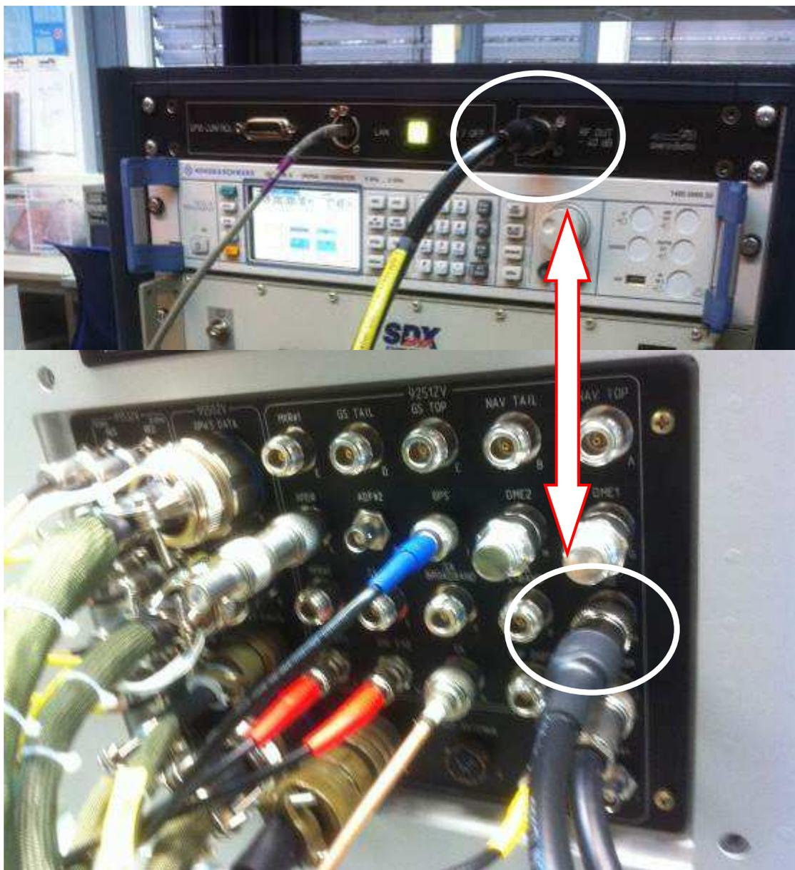
圖 4.4.1.1 [RF OUT]連接到 OPCO 的 RDP [SG]
