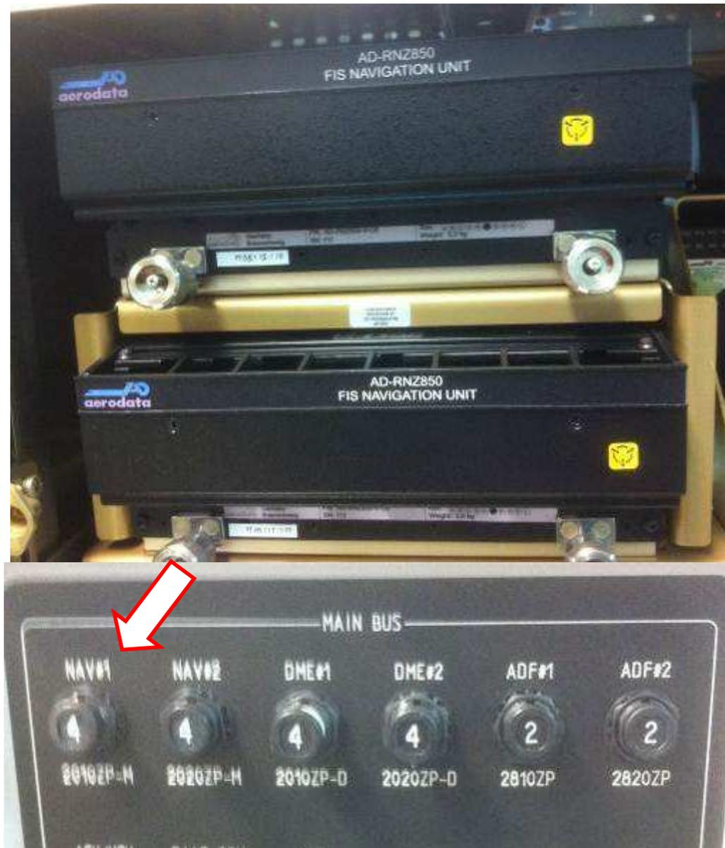
圖 4.4.1.2 NAV#1 電源 Breaker 保護器推入準備就緒
