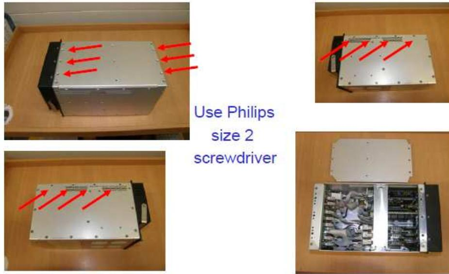
圖 4.3.7 Real-Time-Computer 上方蓋板拆卸方式
