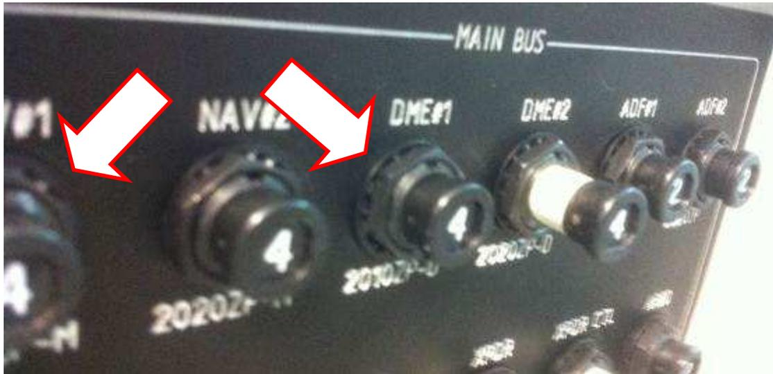
圖 4.4.2.2 NAV#1 與 DME#1 電源 Breaker 保護器推入
