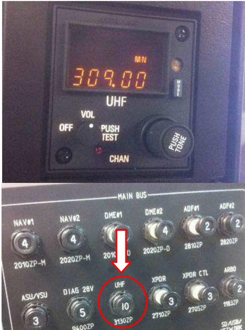
圖 4.4.3.2 UHF 電源 Breaker 保護器推入、接收發射機開啟
