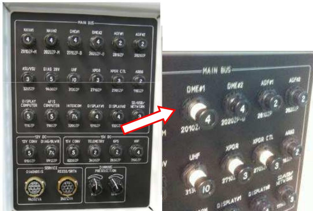
圖 4.3.2 電源 Breaker 保護器拉起，阻絕電源
