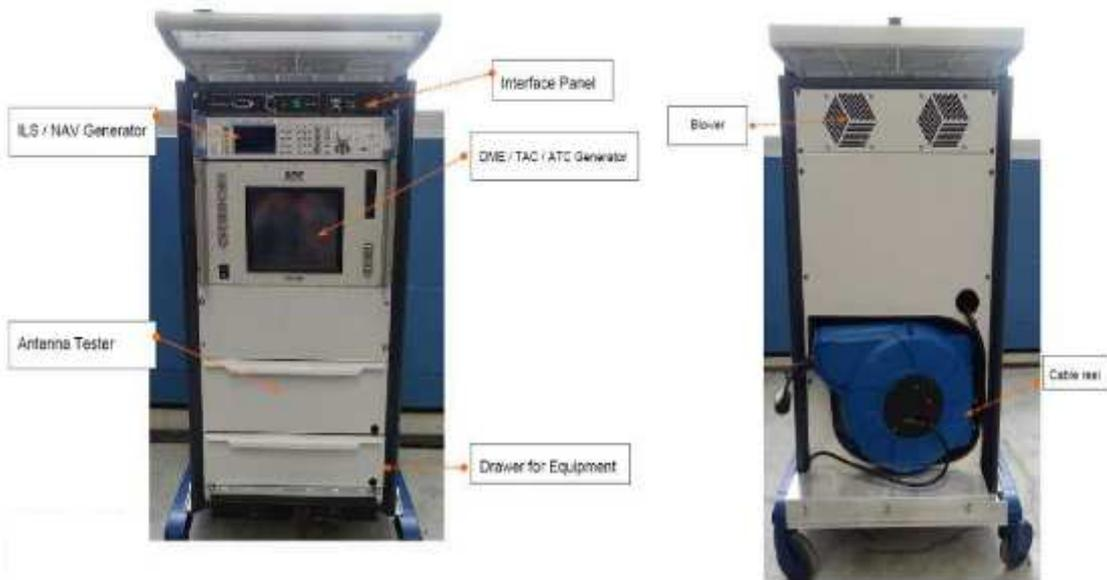
圖 3.1.2 移動式校驗設備外觀圖
