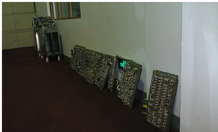
圖 三 型別轉換後卸下的大量面板模組
