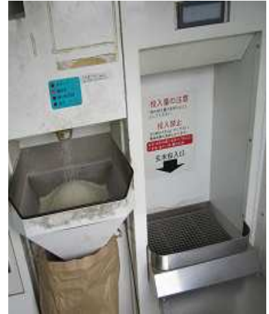
設於賣場停車場的精米屋（左），可依據需求（中）碾成不同精白度的米。右圖為原料米入口及精米出口
