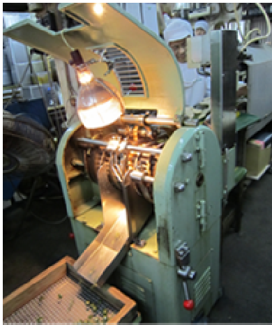
以打錠機將糖飴打錠後，顆粒狀的糖飴落入左下方金屬震動篩中，往前輸送並篩除碎屑
