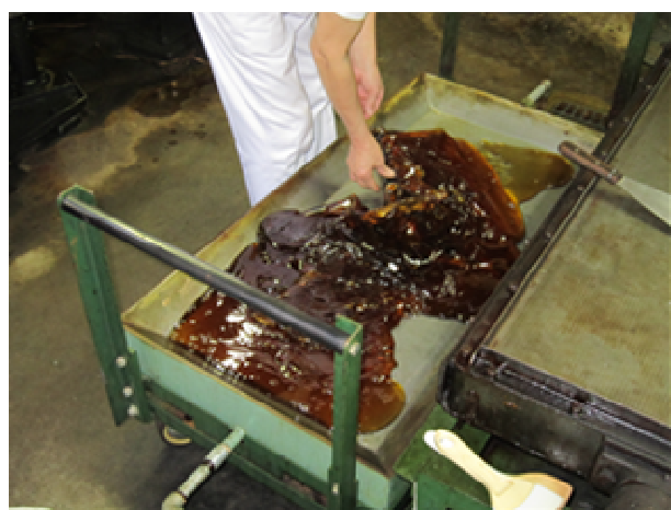
已經融化的原料在金屬檯面上（下面通入流動水冷卻）進行部分冷卻，以便拌入調味配料
