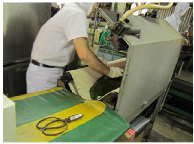
將逐漸冷卻的糖飴以機器保溫，拉成長條狀，準備送入打錠機
