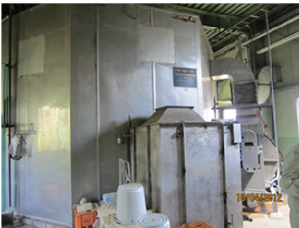
大豆與小麥混合後送入醱酵槽製麴，圖為製麴用的固態醱酵槽
