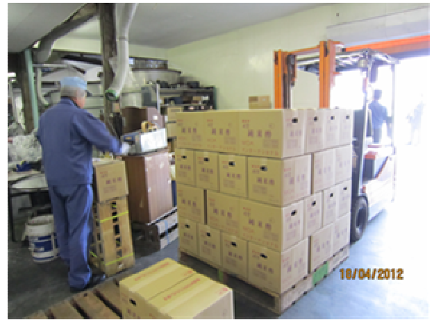
醋的裝箱出貨，箱子的堆疊方式互相交錯，具有防震的效果
