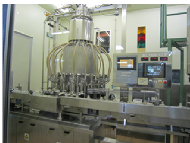
醬料不含防腐劑，是利用無菌室進行熱充填以達到可長期保鮮的效果。圖為無塵室內充填醬料的機器及控制面板
