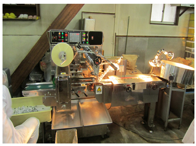
糖飴完全冷卻後進行單顆包裝。糖果由最右邊的圓形筒中落入中間的包裝機，包裝完成的糖果進入照片左側的收集桶中
