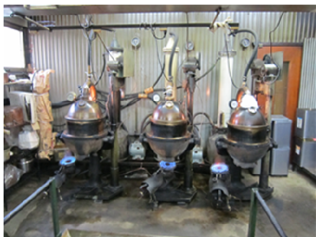
製作糖飴時，融化原料砂糖及麥芽糖用的加熱器
