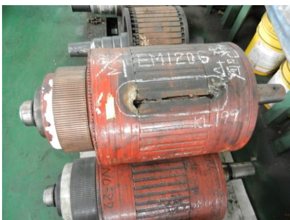
圖 4 楔部之鬆弛造成之轉部損壞
