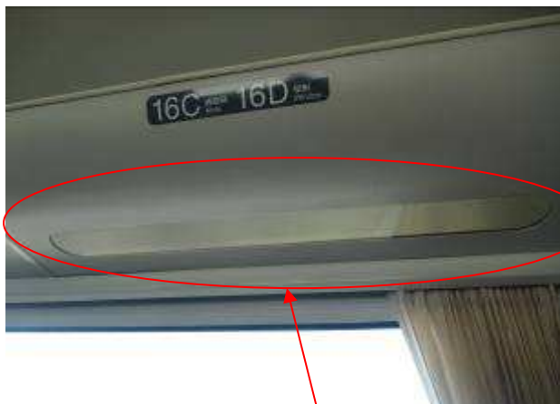
圖 左為 JR 北海道特急超級大空號(札幌→釧路)スーパーおおぞら(OZORA)5号行李架，行李架採板式設置，旅客放置行李容易，中間為透明壓克力板，旅客拿取行李後，可透過該處檢視有無遺漏之行李。
