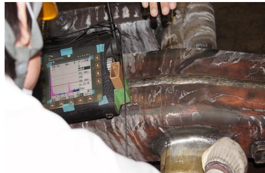
圖 16 轉向架架框關鍵銲道非破壞性檢驗
