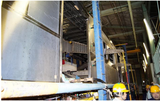
圖 17 垂直荷重試驗 1
