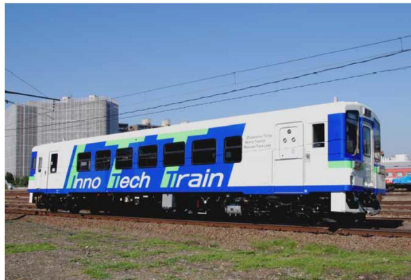
写真: モーターアシスト式ハイブリッド駆動システムを搭載したITT (Innovative Technology Train)
