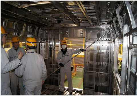
圖 11 車輛構體尺寸檢查 1
