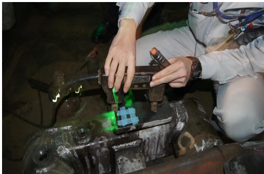
圖 15 轉向架架框目視檢查
