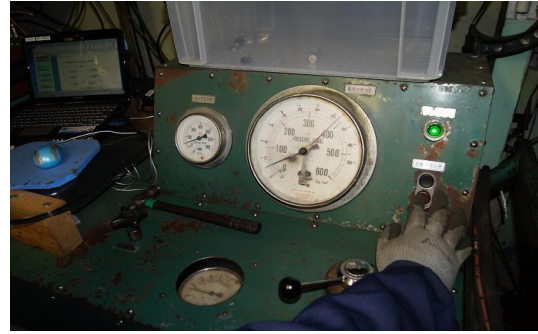
圖 18 垂直荷重試驗 2
