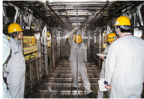
圖 12 車輛構體尺寸檢查 2
