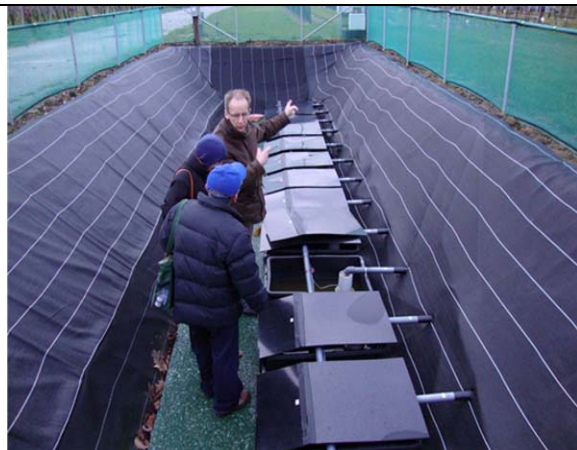
PPO 果樹實驗站 Rien van der Maas 先生介紹實驗站內果樹肥培試驗之滲漏液監測設備，養分利用率為荷蘭化肥政策及重要的參考資訊
