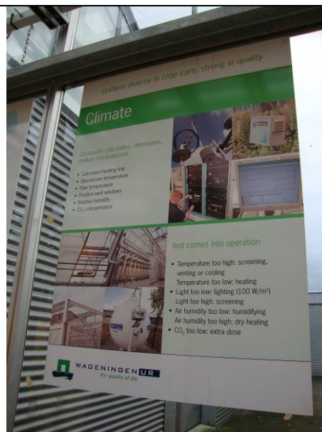
溫室管理廠商張貼於溫室內的海報，該公司可依研究人員需求代為設計符合試驗目的的溫室軟硬體，包括環境監測及自動控制設備
