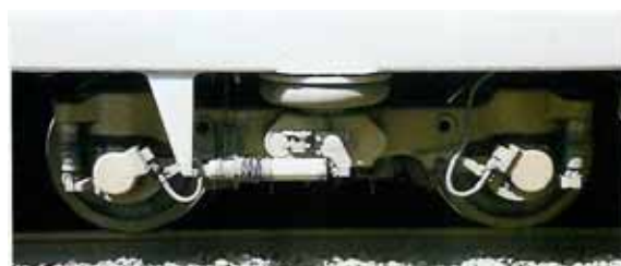
照片 2-90 WTR300 轉向架碟剎與踏面剎車併用
