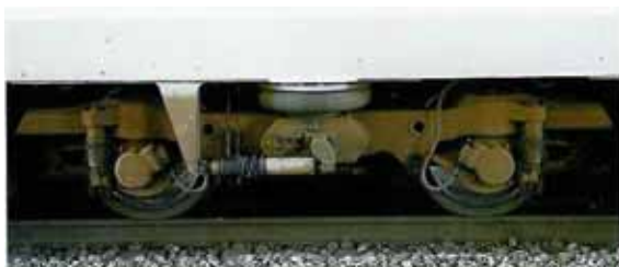
照片 2-89 WDT300 轉向架卡鉗式碟剎
