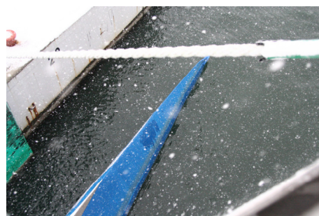
圖 12 船舶刀型切浪結構
