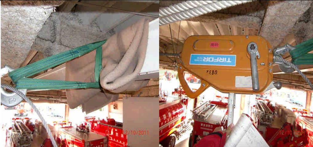
圖 43：固定點的用法及使用器材拉主繩
