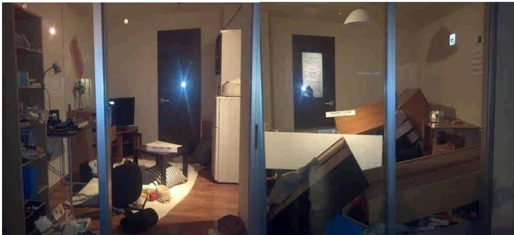
圖 8：左－主要傢俱有防震設置、右－主要傢俱無防震設置
