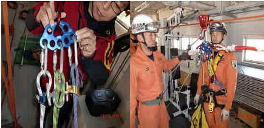
圖 44：下降時器材的配置方式
