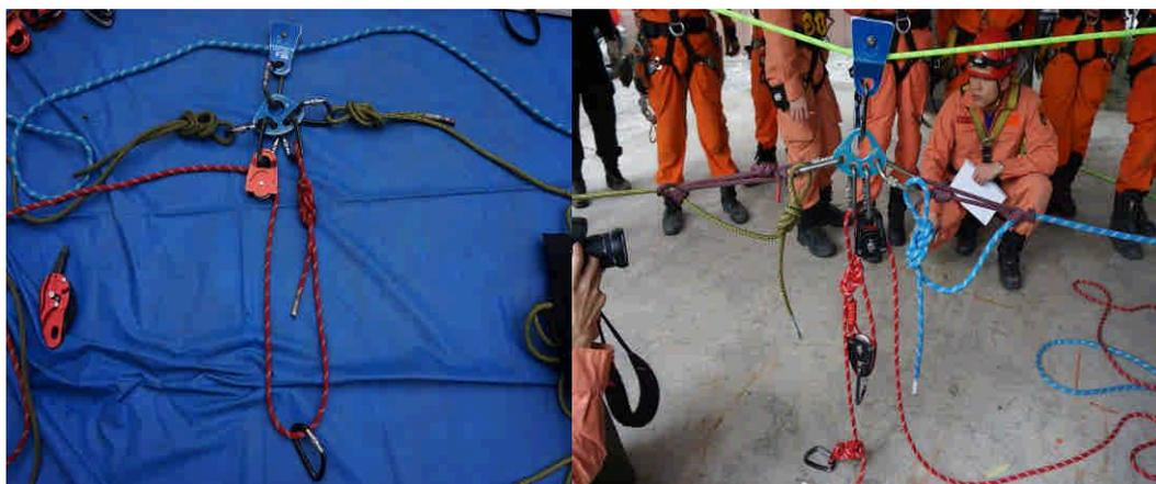
圖 46：T 型救援的器材使用方式
