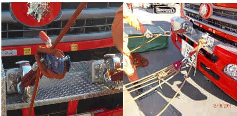
圖 40：使用編織繩固定點的確保方式
