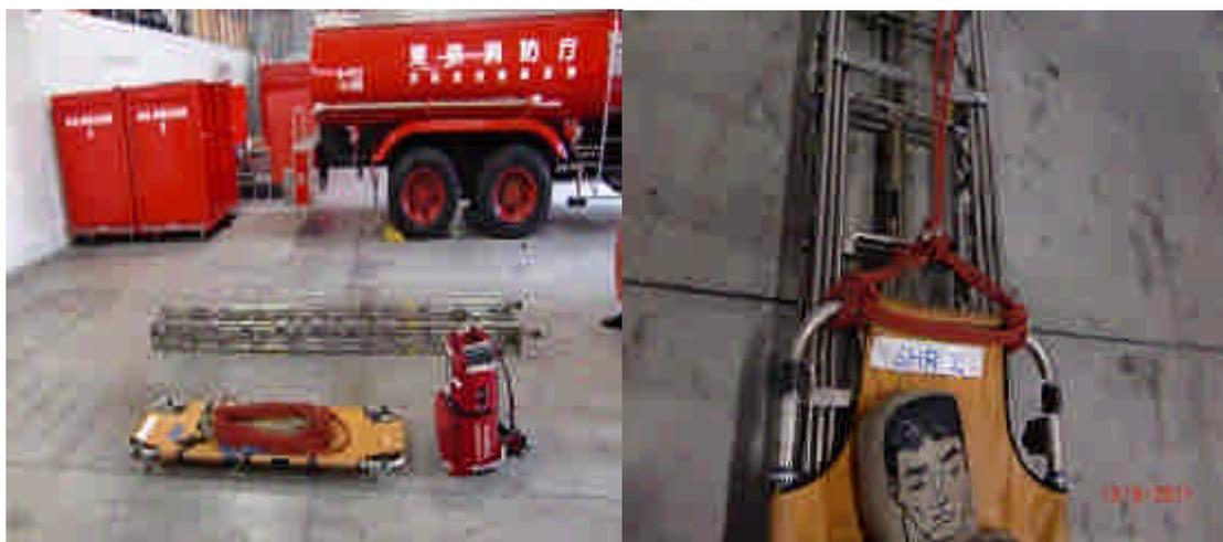
圖 23：水平救出第一式所使用的器材 圖 24：使用雙股特多龍繩當主繩
