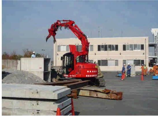
圖 67：雙腕重機具移除障礙物
