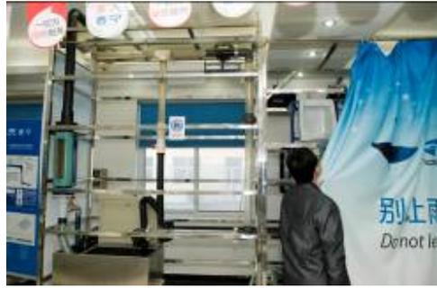
圖 36 及圖 37 虹吸式屋頂落水頭實驗裝置
