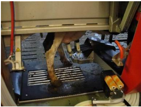
自動擠乳機器人擠乳情形。
