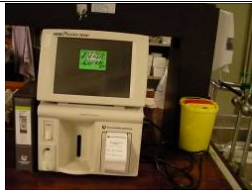
人工氣候室專用血液氣體分析儀，可立即採血測定血中 pH 值、鹼藏及氣體等含量。
