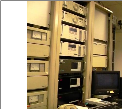
代謝室各種氣體控制與監控操作系統，包括氧、二氧化碳、甲烷及氮氣等濃度。
