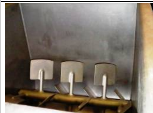
飼料原料混合桶內部為螺葉片型態(與台灣傳統螺旋式不同)。
