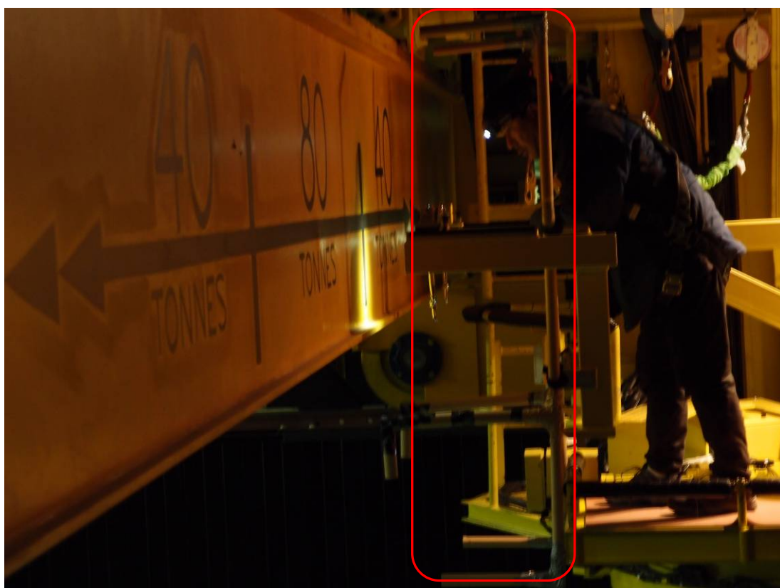
圖 35 光學濾鏡交換機構模擬框架干涉距離量測。
