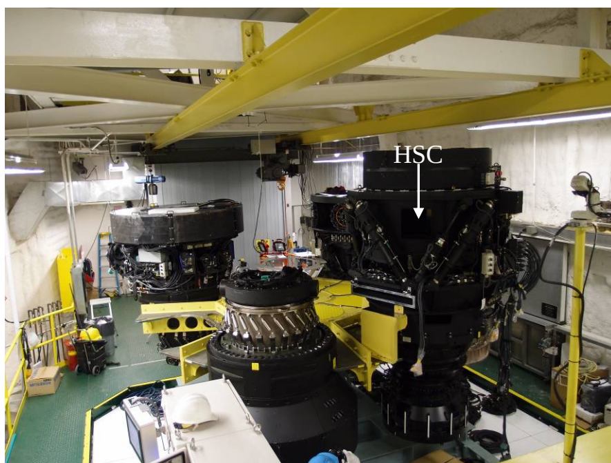
圖 13 速霸陸望遠鏡不同功能鏡頭存放區及轉換機構。
