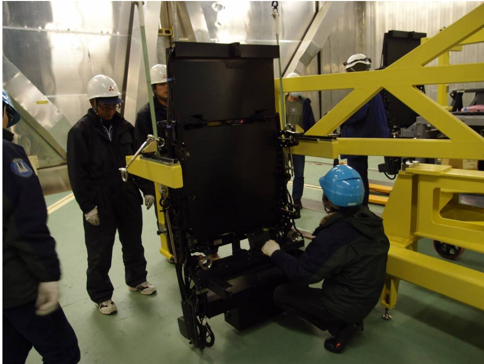
圖 22 光學濾鏡交換機構端安裝於組裝型架。
