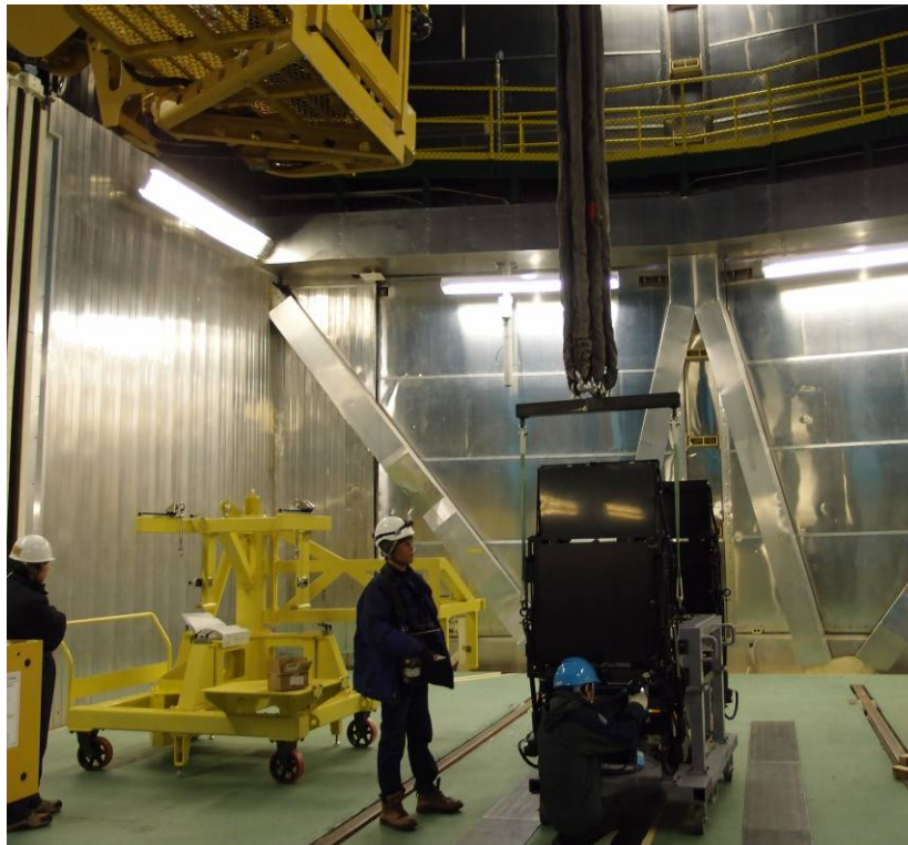
圖 18 紅外線濾鏡交換機構端由測試架吊移至組裝型架。
