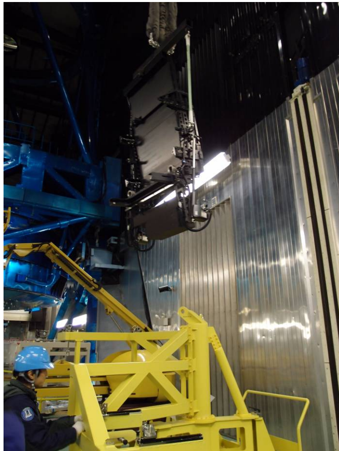
圖 21 光學濾鏡交換機構端由測試架吊移至組裝型架。
