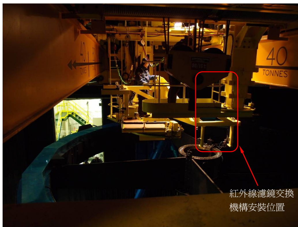
圖 29 紅外線濾鏡交換機構安裝型架干涉測試。
