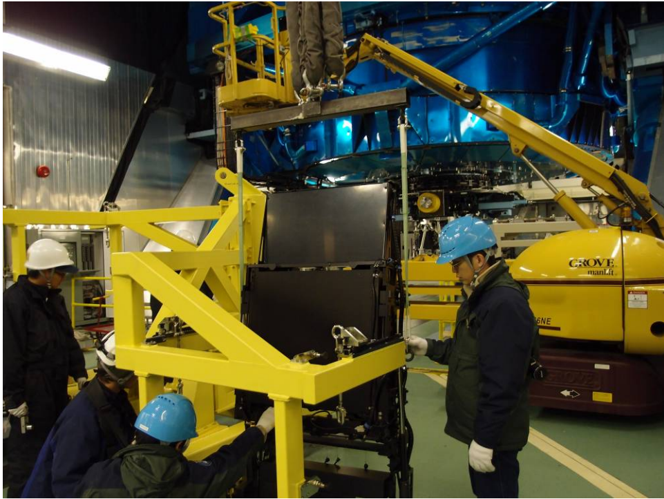
圖 20 紅外線濾鏡交換機構端安裝於組裝型架。
