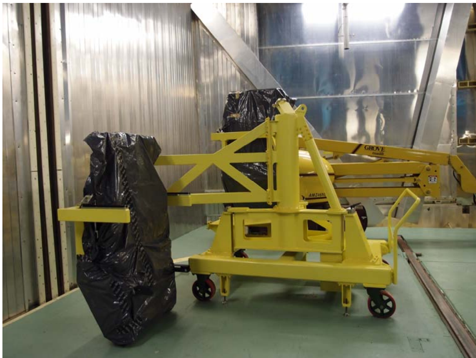
圖 43 濾鏡交換機構實體執行安裝預配完成，安裝回組裝型架搬運車並進行保護措施，等待正式安裝。
