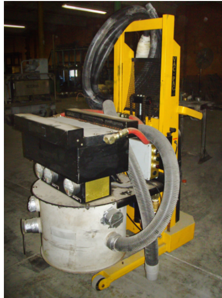
圖六、集塵設備
